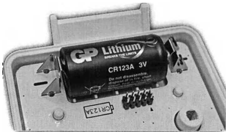
Рисунок 8 – Установленная батарея в разобранном приборе.
