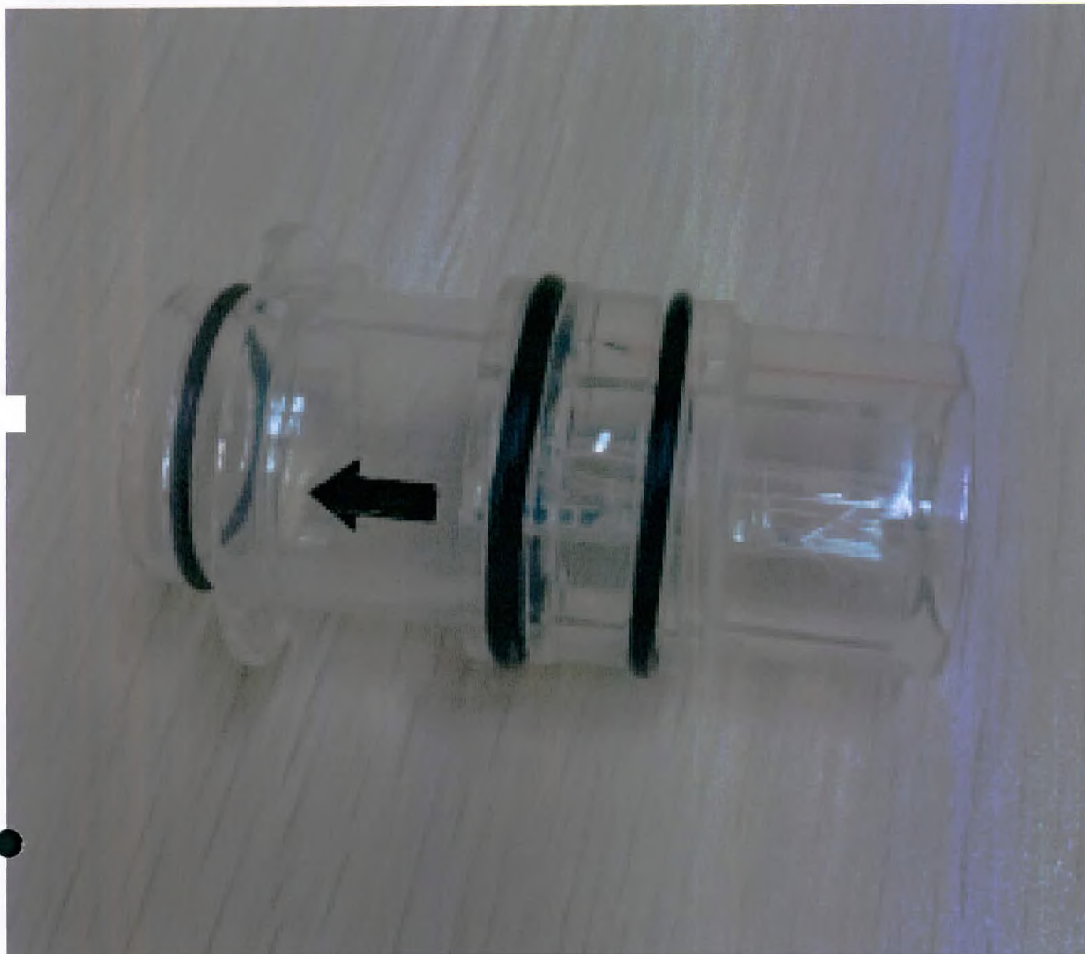
Датчик потока инспираторный, автоклавируемый не более 20 шт. (при необходимости)
