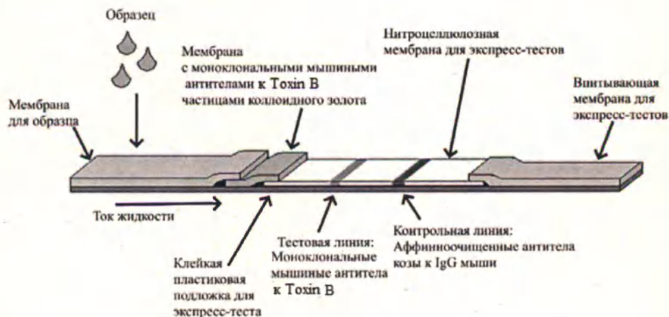
Рисунок 4. Схема тест-полоски для определения Toxin B
