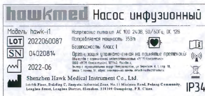
Рис. 1. Пример маркировки инфузионного насоса hawk-i1.
