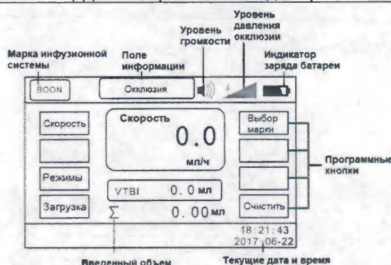
Рис. 5. Инфузионный насос НК-100II. Информация на экране.
