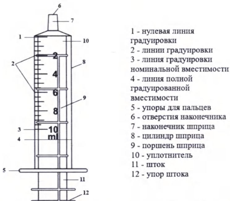
Рисунок 4 – Пример внешнего вида шприца потери сопротивления, 10 мл, Luer (Луер) с указанием составных частей изделия.
