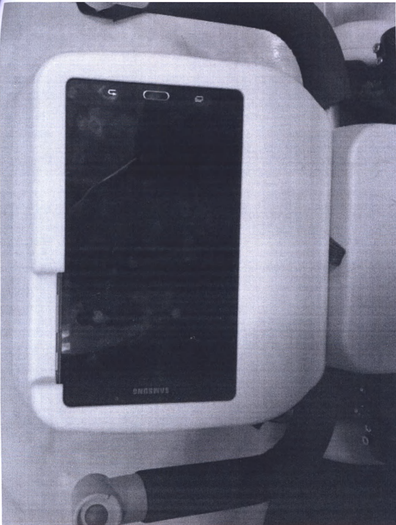
Рисунок 1.7 – Компьютер планшетный встраиваемый с программным обеспечением ExoAtlet® Bambini, версии 1.x.x.
