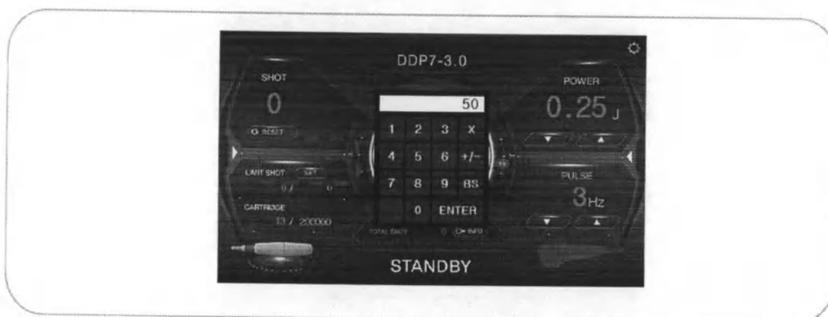
Рисунок 15 – Экран установки лимита импульсов
