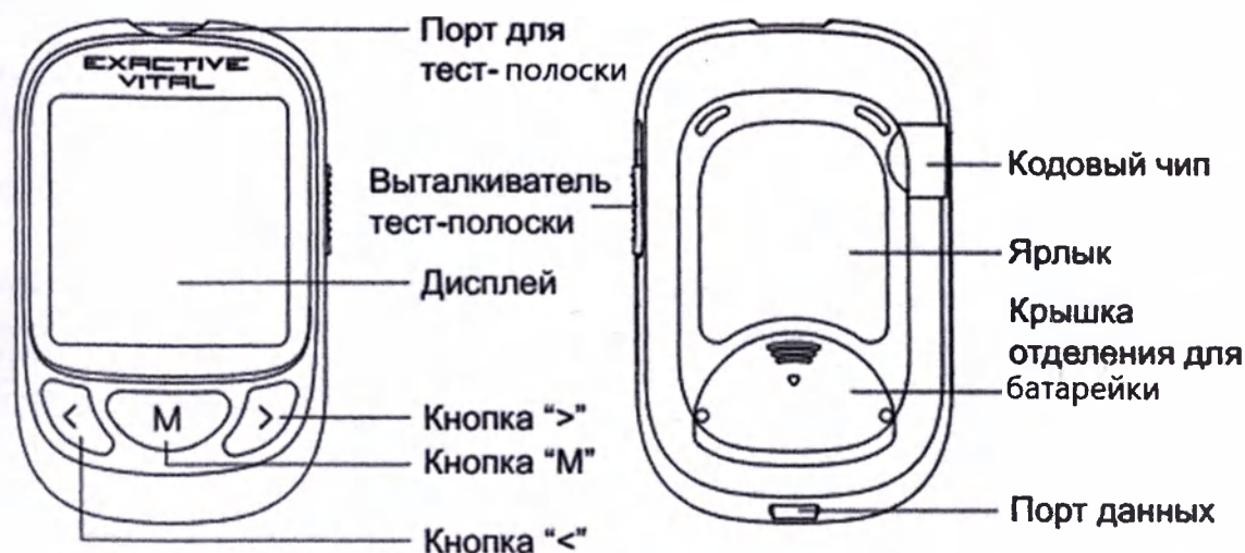
Рисунок 2 – Схематичное изображение глюкометра
