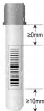
Рисунок 4-1 Крепление штрих-кода на пробирку
