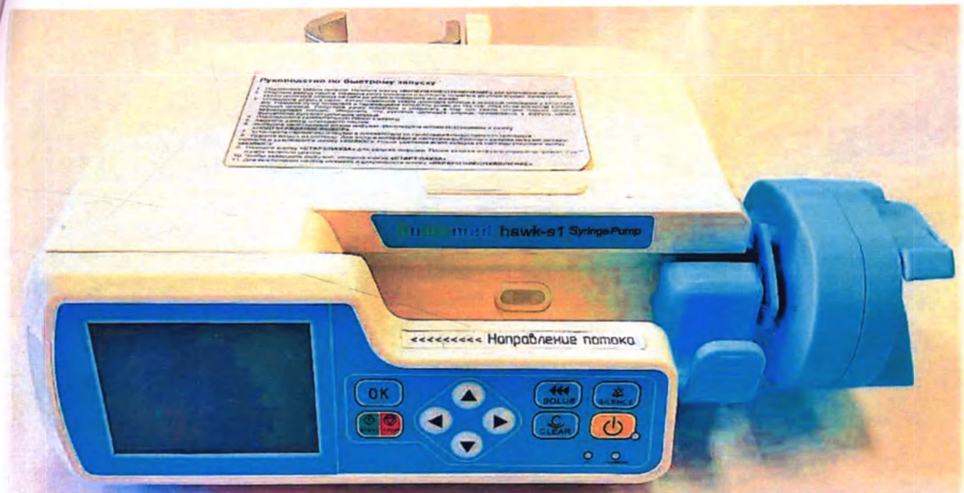
Фотографическое изображение насоса шприцевого hawk-s1: основной блок с батареей и зажимом для крепления к стойке (вид спереди).
