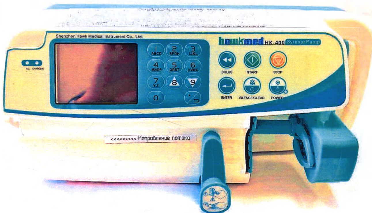
Фотографическое изображение насоса шприцевого НК-400: основной блок с батареей и зажимом для крепления к стойке (вид спереди).
