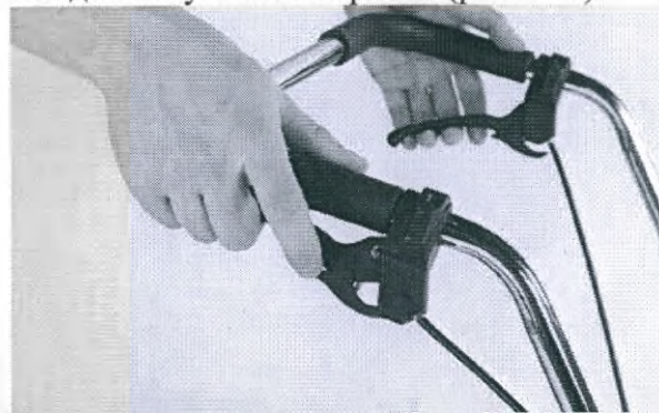
Рисунок 71. Приведение в действие тормоза
