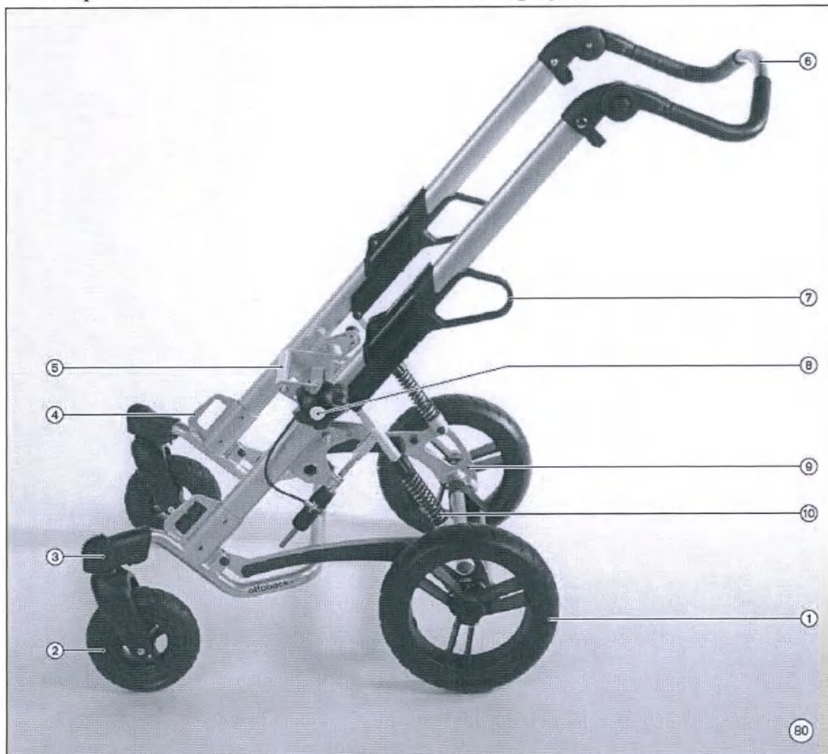
Рисунок 35. КИМБА Нео – прогулочное шасси с передними колесами с жесткой конструкцией: 1. Съемное заднее колесо; 2. Съемное переднее колесо с жесткой конструкцией; 3. Крепежная петля, передняя; 4. Крепежный захват сиденья; 5. Съемное сиденье с боковыми ограничителями; 6. Регулируемая ручка для сопровождающего лица; 7. Деблокиратор складного механизма; 8. Модуль регулировки угла наклона сиденья на шасси; 9. Крепежная петля, задняя; 10. Амортизаторы
