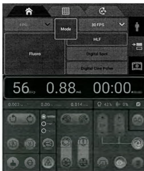
Рисунок 5-21: Окно Mode (Режим) на ОЕС Touch / Touch Tableside панели управления С-образной дугой
