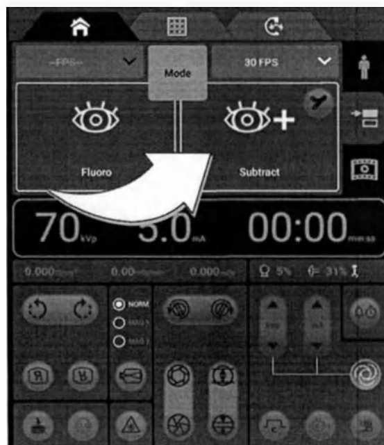
Рисунок 5-32: Кнопка Subtract (Вычитание) (со значком для контрастного вещества для получения негативных изображений) на панели управления С-образной дугой Touch / Touch Tableside
