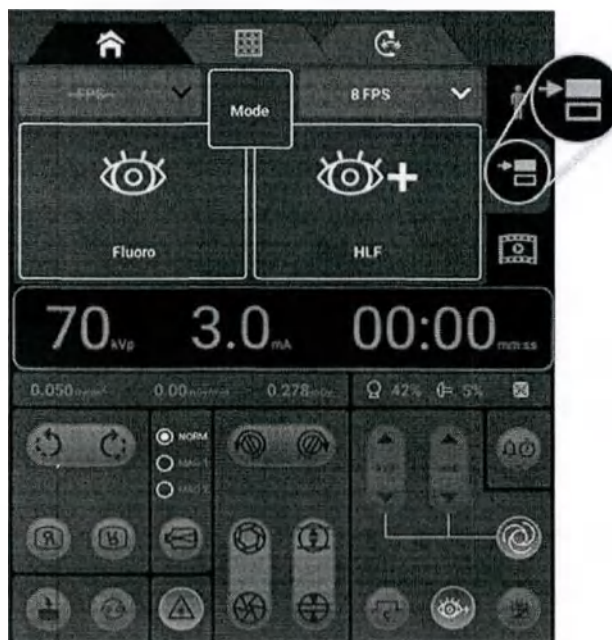
Рисунок 5-20: Кнопка Mode (Режим) на ОЕС Touch / Touch Tableside панели управления С-образной дугой
