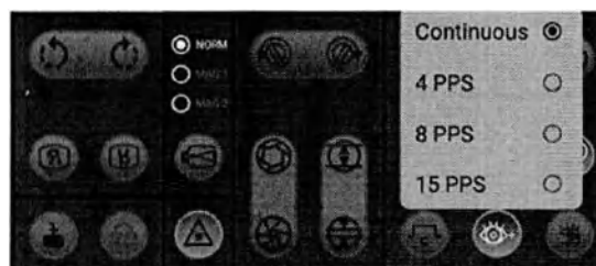
Рисунок 5-29: Скорость импульсов на ОЕС Touch / Touch Tables панели управления С-образной дугой
