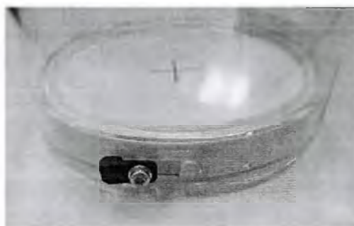
Рисунок 3-47: Позиционер разблокирован, готов к снятию
