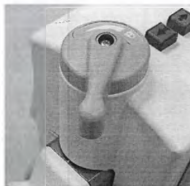
Рисунок 3-63: Тормоз горизонтальной поперечины в положении полной блокировки (слева) и полной разблокировки (справа)
