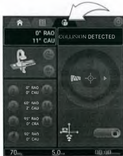
Рисунок 3-112: Значок состояния приводного механизма на панели позиционирования С-образной дуги
