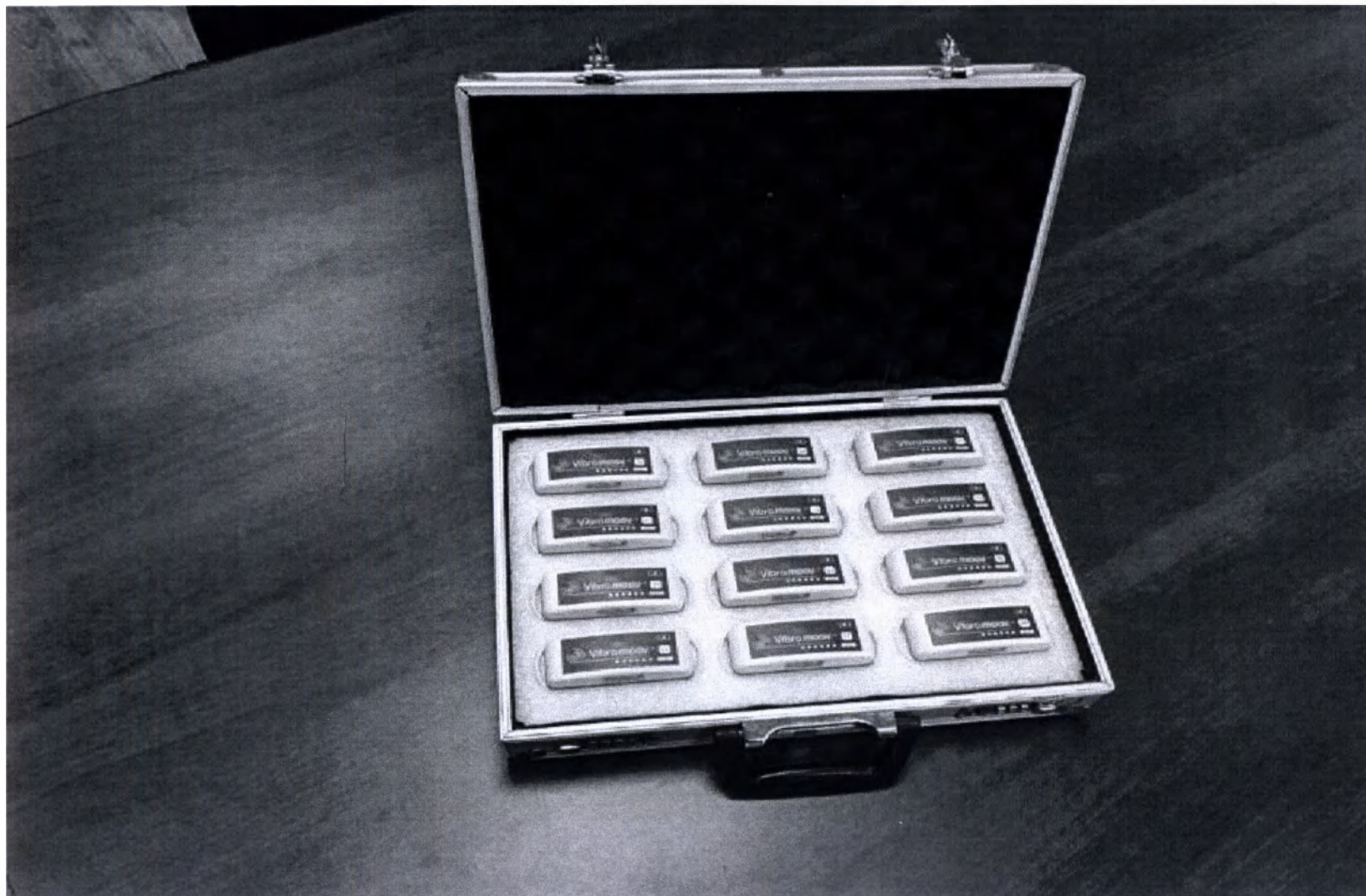
Беспроводные источники вибрации (в металлическом чемоданчике)
