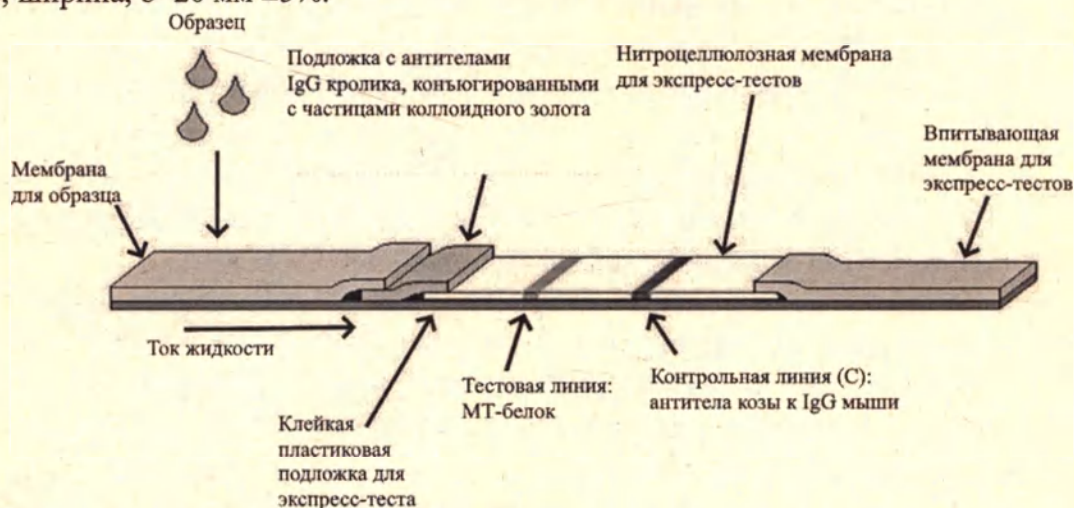
Рисунок 1. Схема тест-полоски
