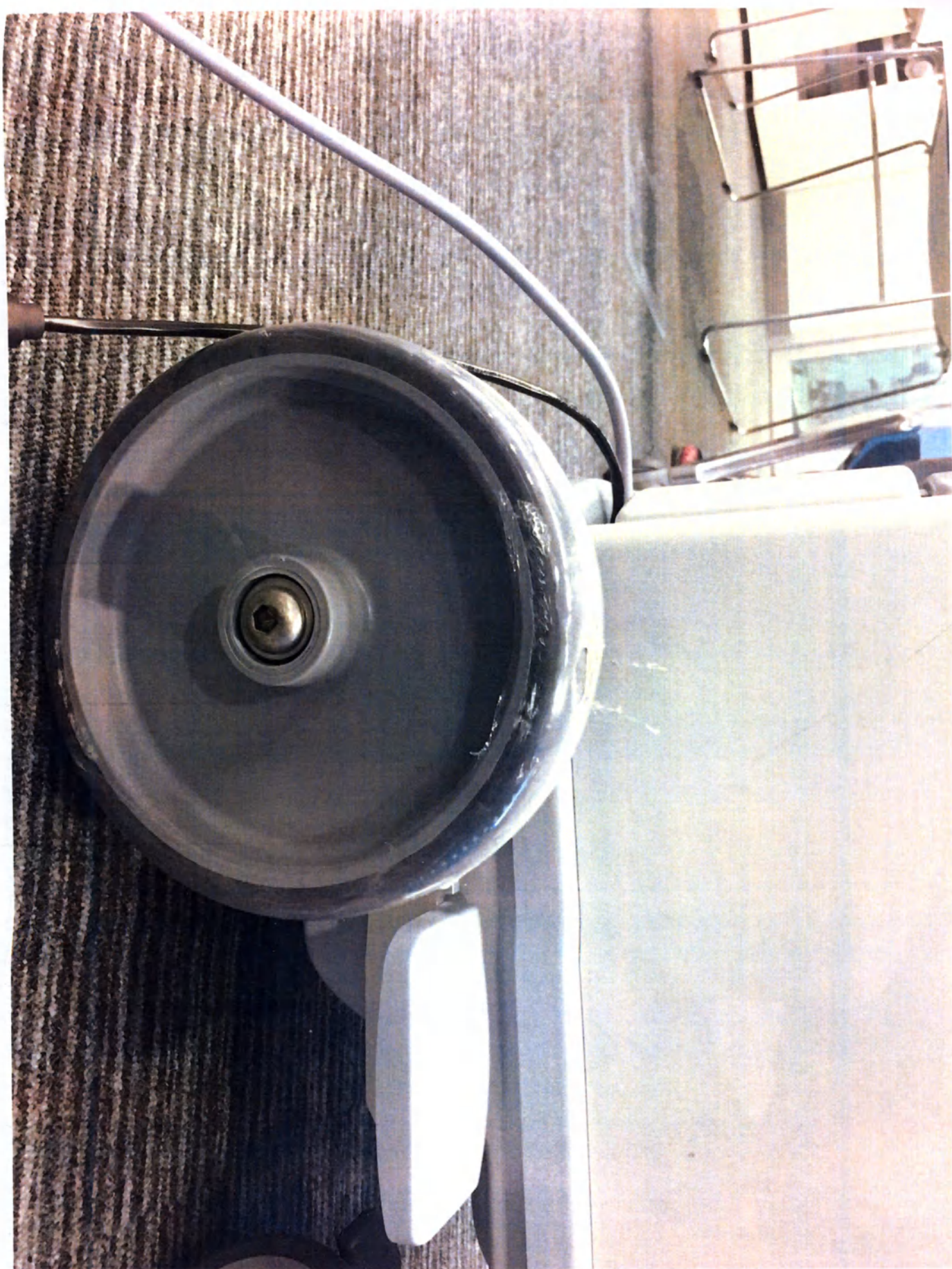
Задние колеса с педалью блокировки консоли AngioJet Ultra 5000A
