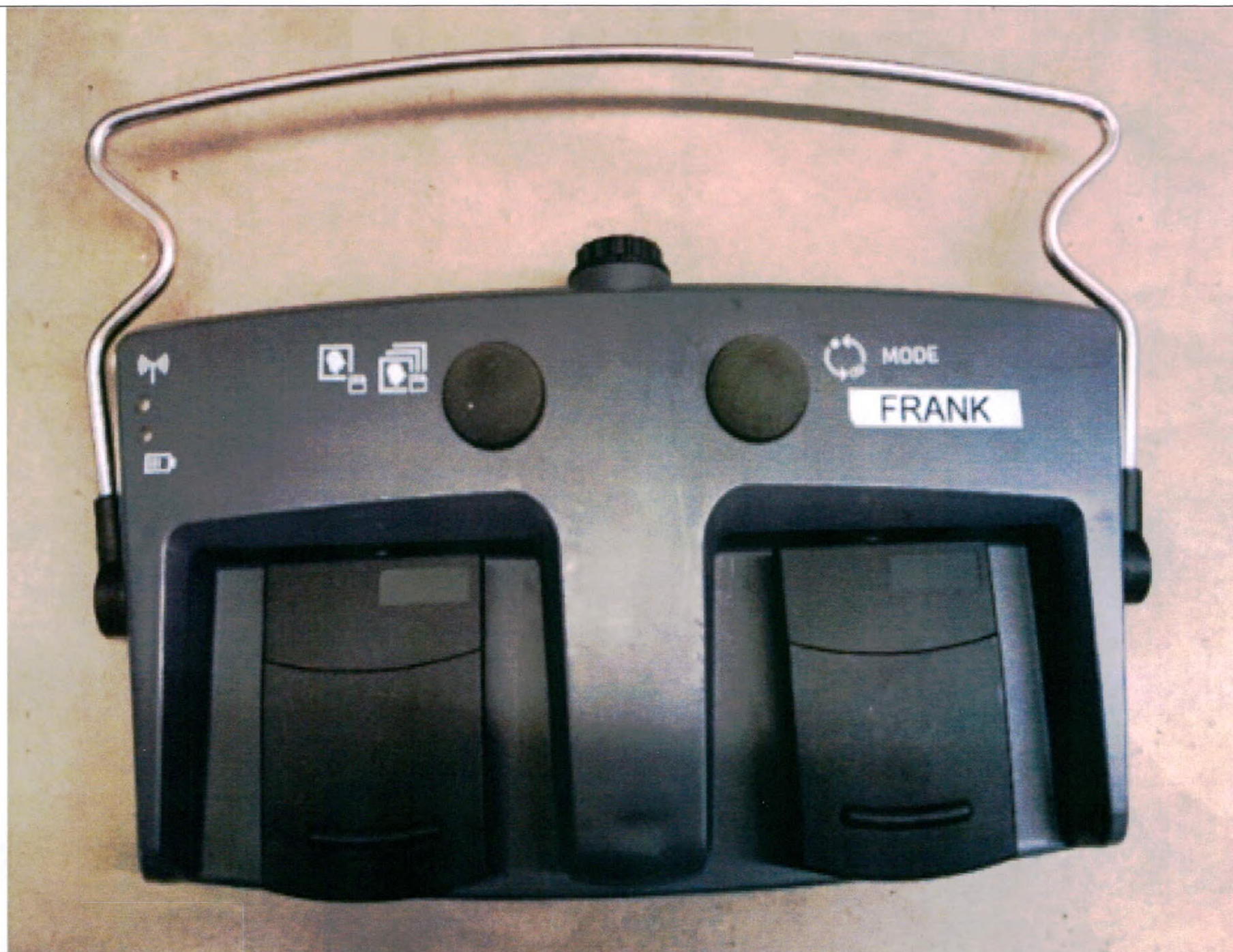
Дополнительный ножной переключатель, вариант исполнения: беспроводной многофункциональный напольный переключатель
