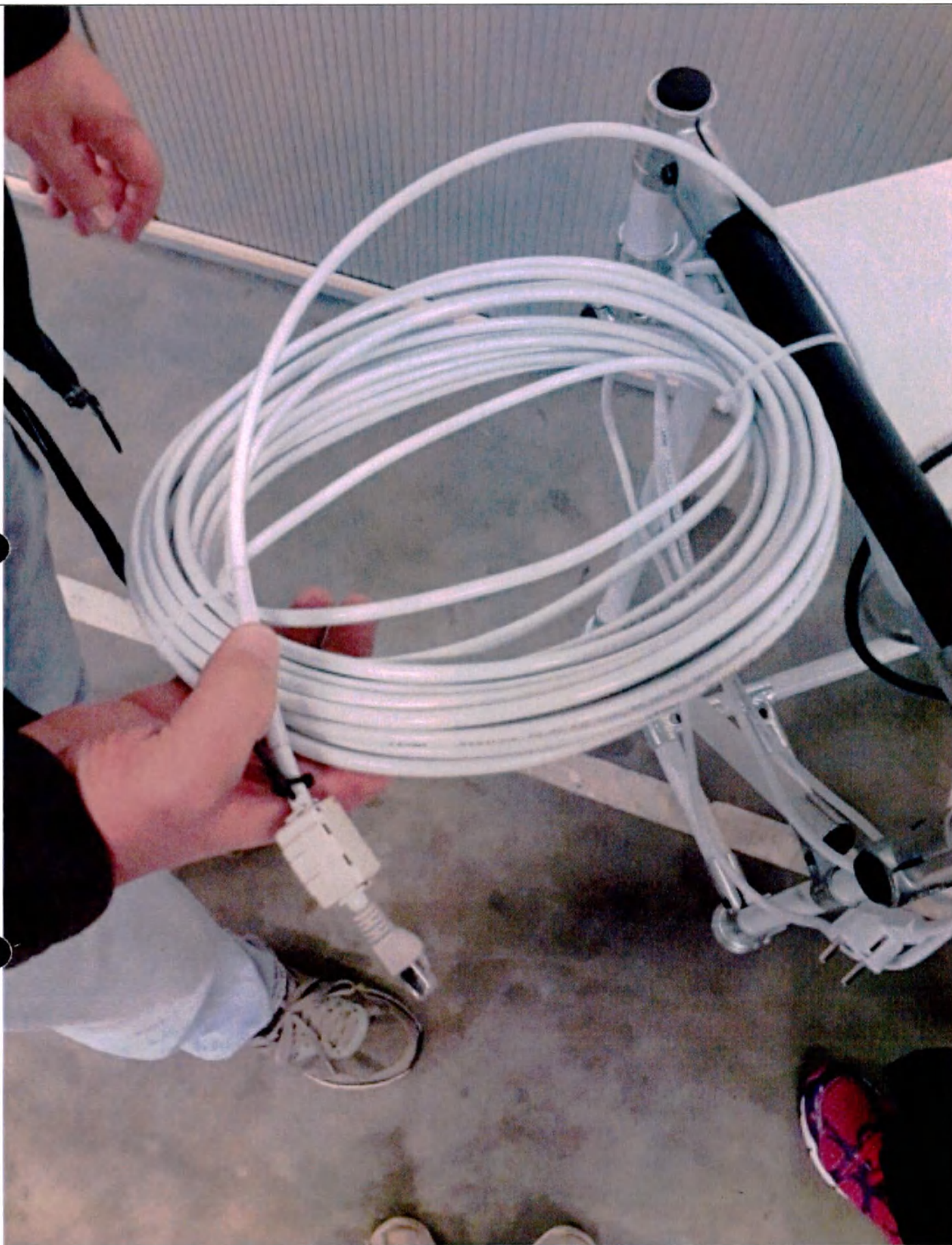
Сетевой видеокабель с адаптером электропитания для разветвителя видеосигнала
