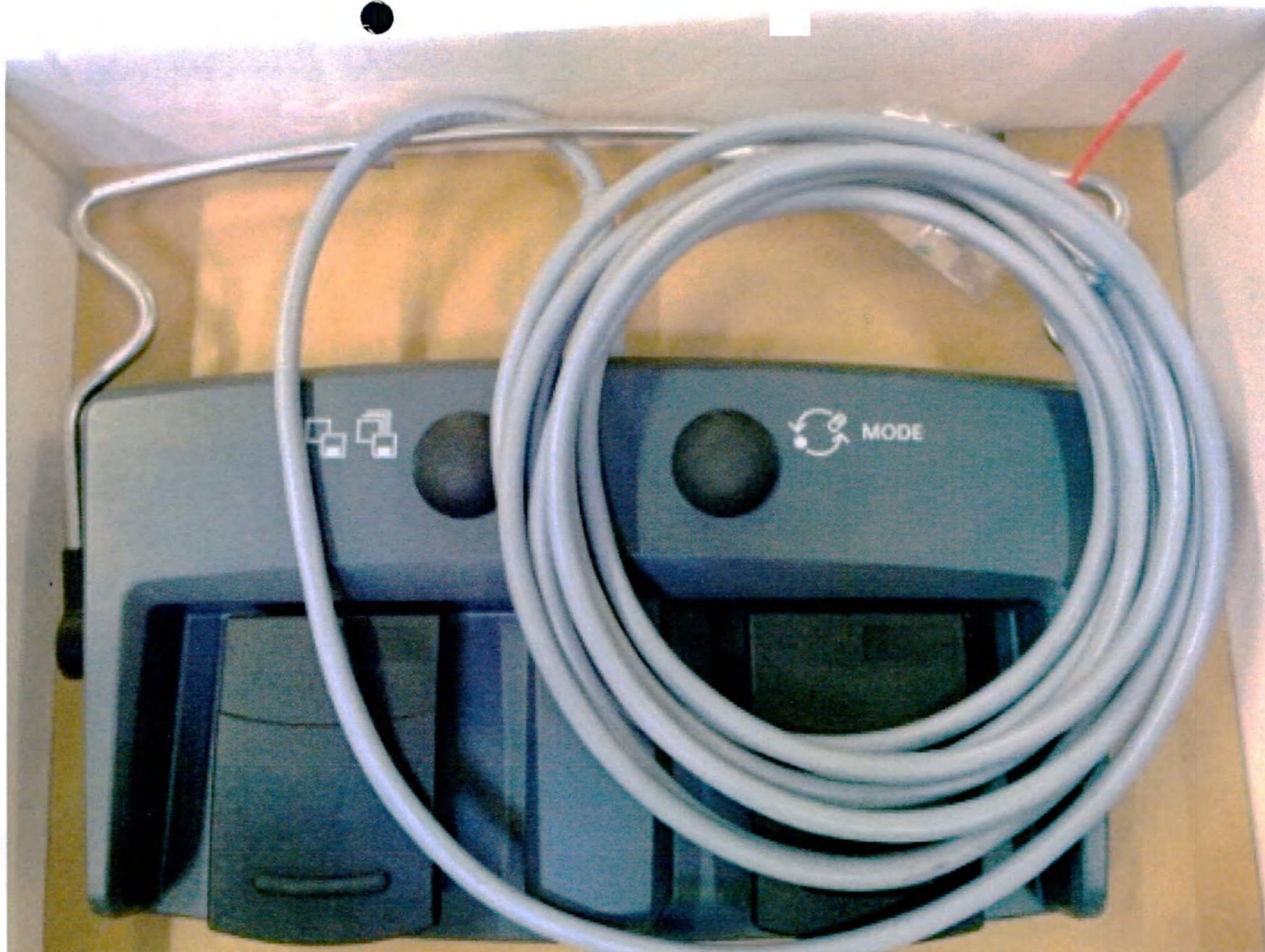
Педальный переключатель, вариант исполнения: многофункциональный напольный переключатель
