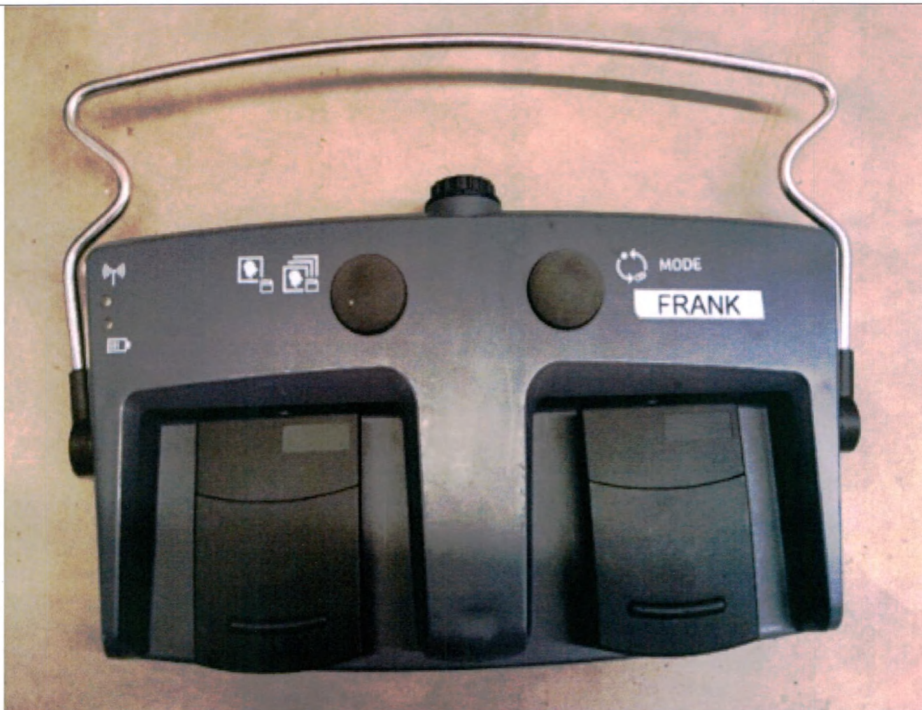
Педальный переключатель, вариант исполнения: беспроводной многофункциональный напольный переключатель
