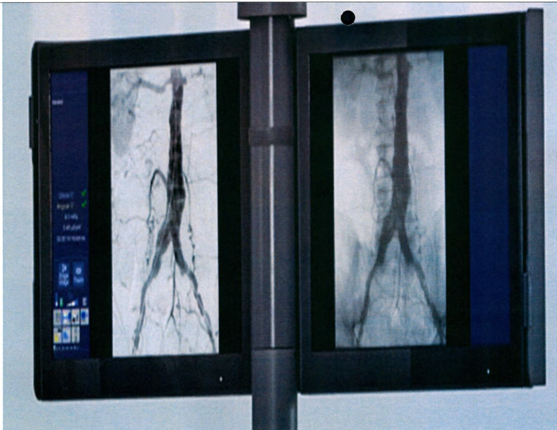
Мониторная стойка. Цветные TFT-мониторы, варианты исполнения: 2 цветных TFT-монитора повышенной яркости
