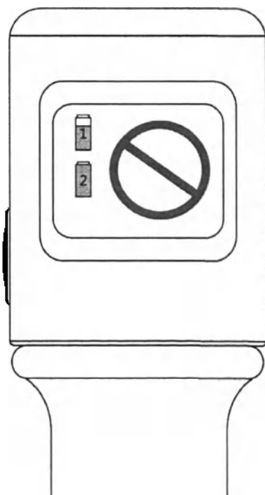
Рисунок 6 – Режим работы Экзоскелета с пульта управления беспроводного не активирован.
