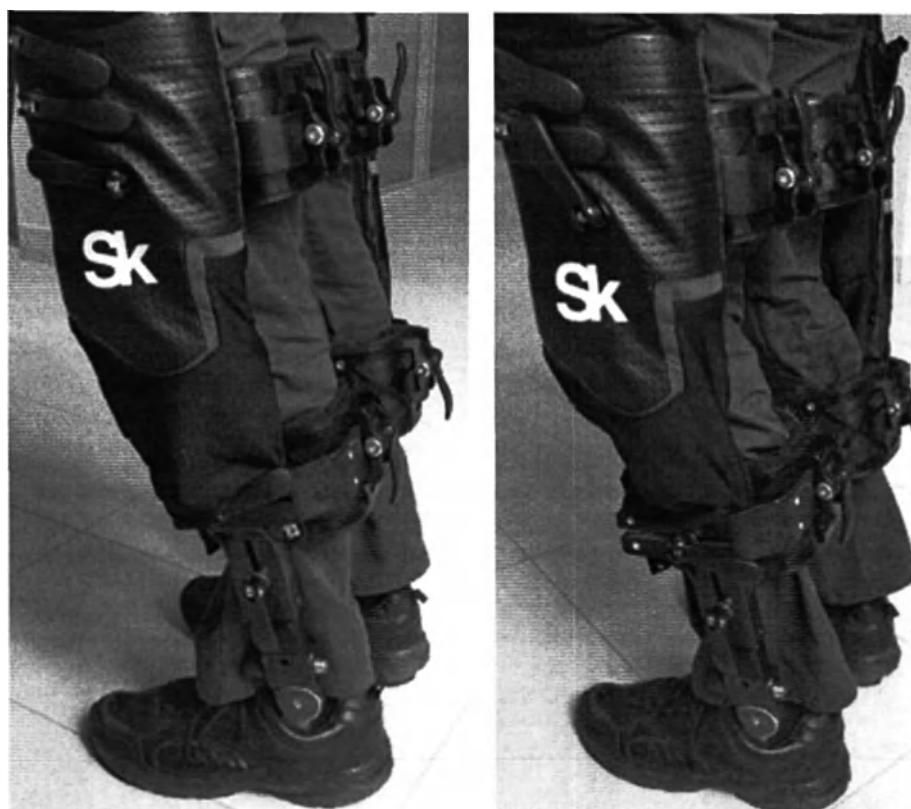
Рисунок 55 - Слева правильный угол сгиба колена. Справа – неправильный угол сгиба.
