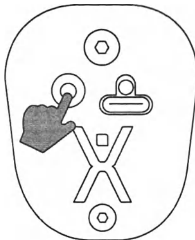
Рисунок 7 – Включение пульта управления беспроводного.
