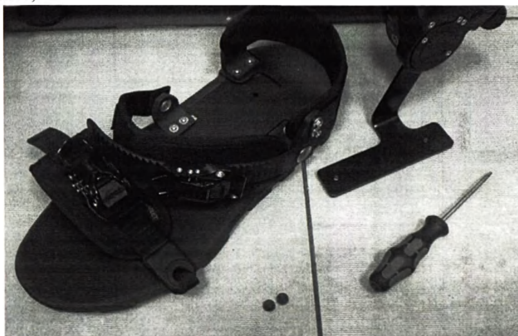
Рисунок 15 – Подготовка креплений стопы к установке на Экзоскелет.
