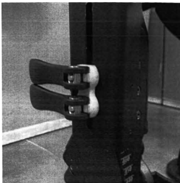
Рисунок 17 – Зажимные рукоятки механизма регулировки длины голени Экзоскелета.
