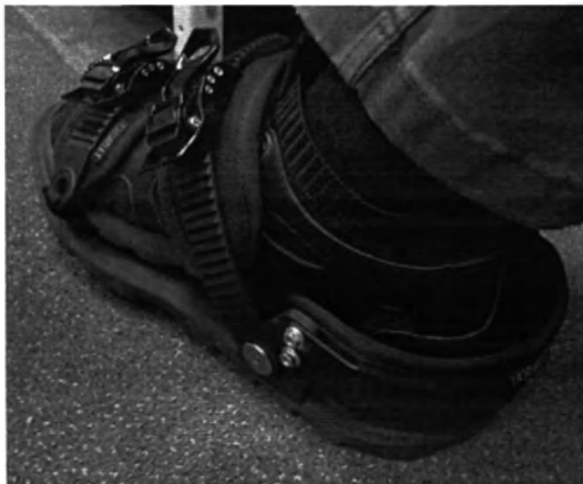
Рисунок 39 – Установка стоп Пациента в Экзоскелете, пятка упирается в подпяточник.
