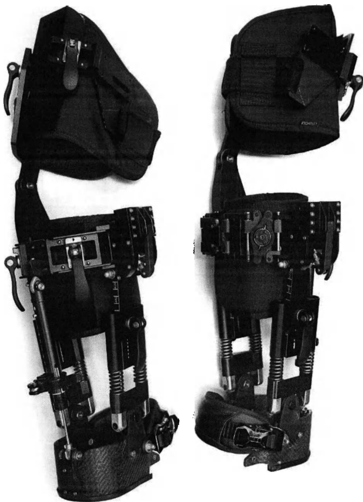
Рисунок 2.7 – Комплект голени с усиленной амортизацией, в составе: - голень левая с усиленной амортизацией с возможностью установки тензометрических датчиков; - голень правая с усиленной амортизацией с возможностью установки тензометрических датчиков.
