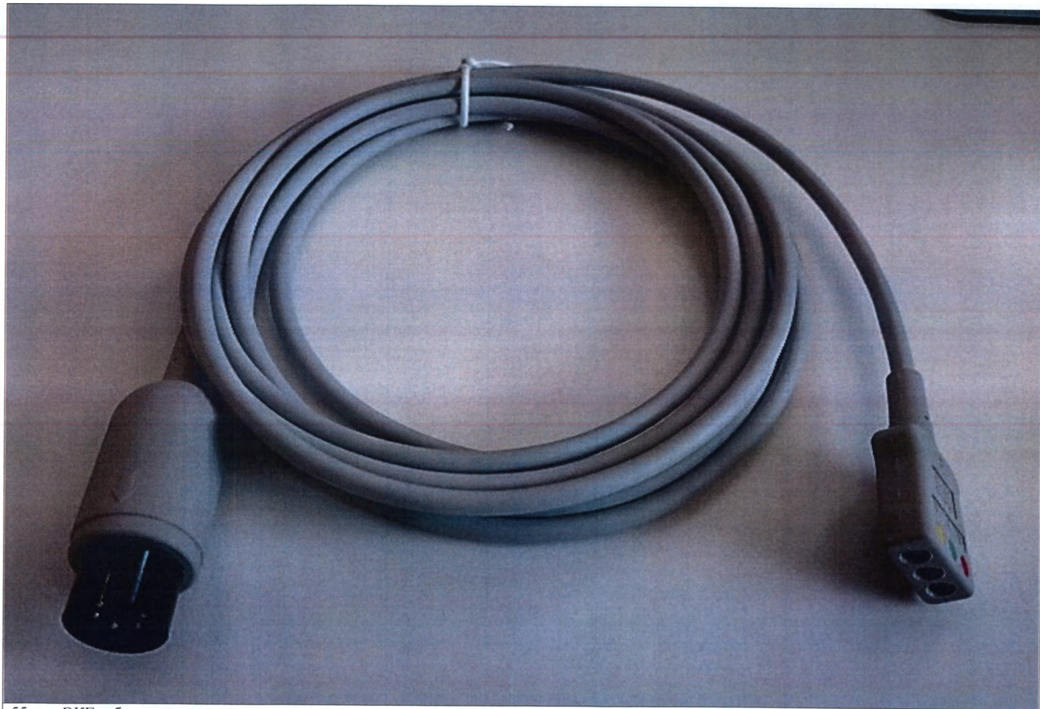
55. ЭКГ кабель монитора для подключения неонатальных электродов.
