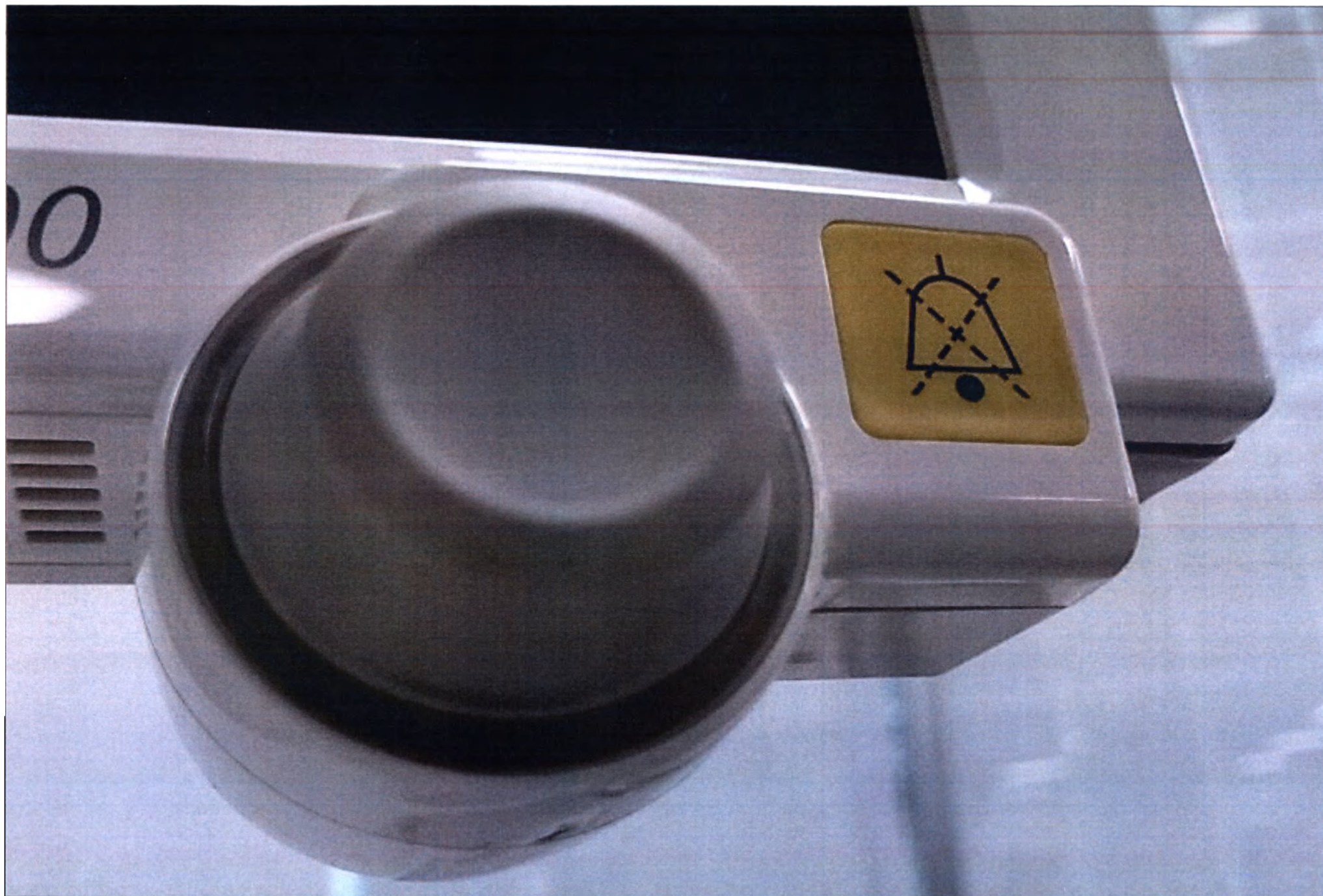
30. Вращающаяся ручка управления информационного терминала.
