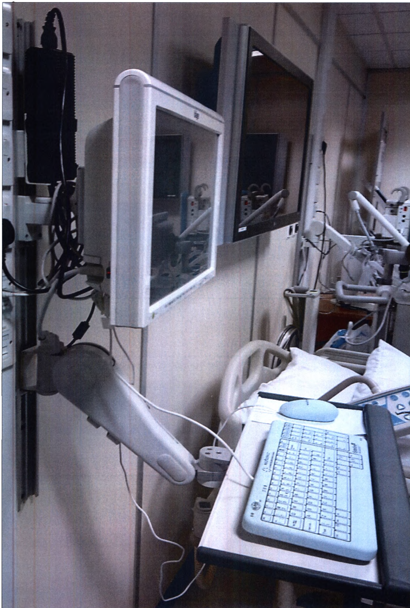
35. Кронштейн крепления дисплея / медицинского информационного терминала на стену.
