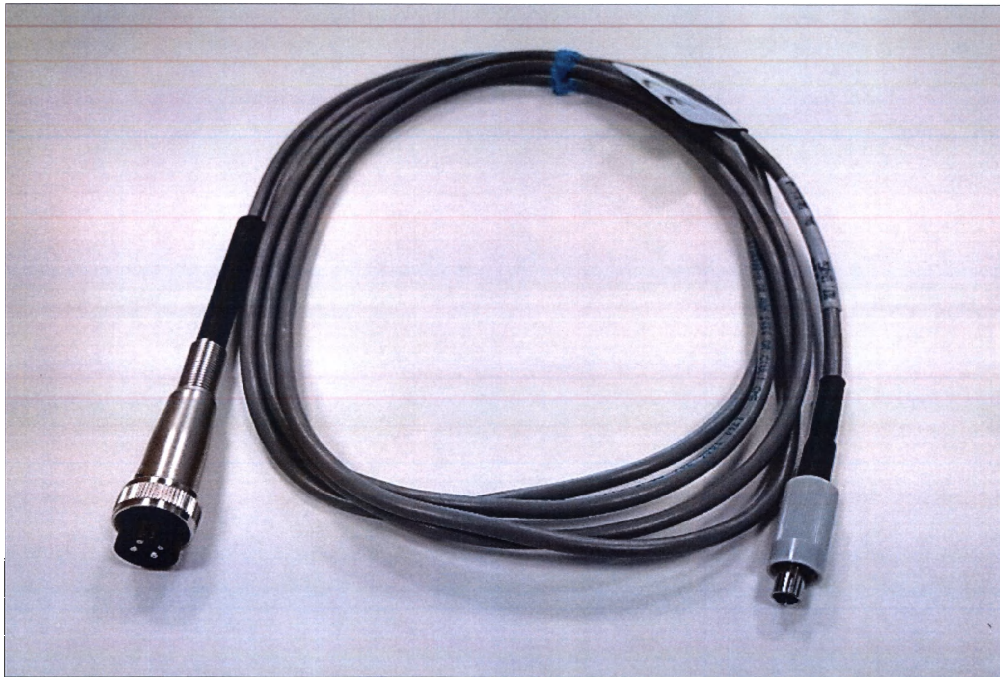
89. Адаптер подключения термистора к линии введения термодиллюзионного раствора.
