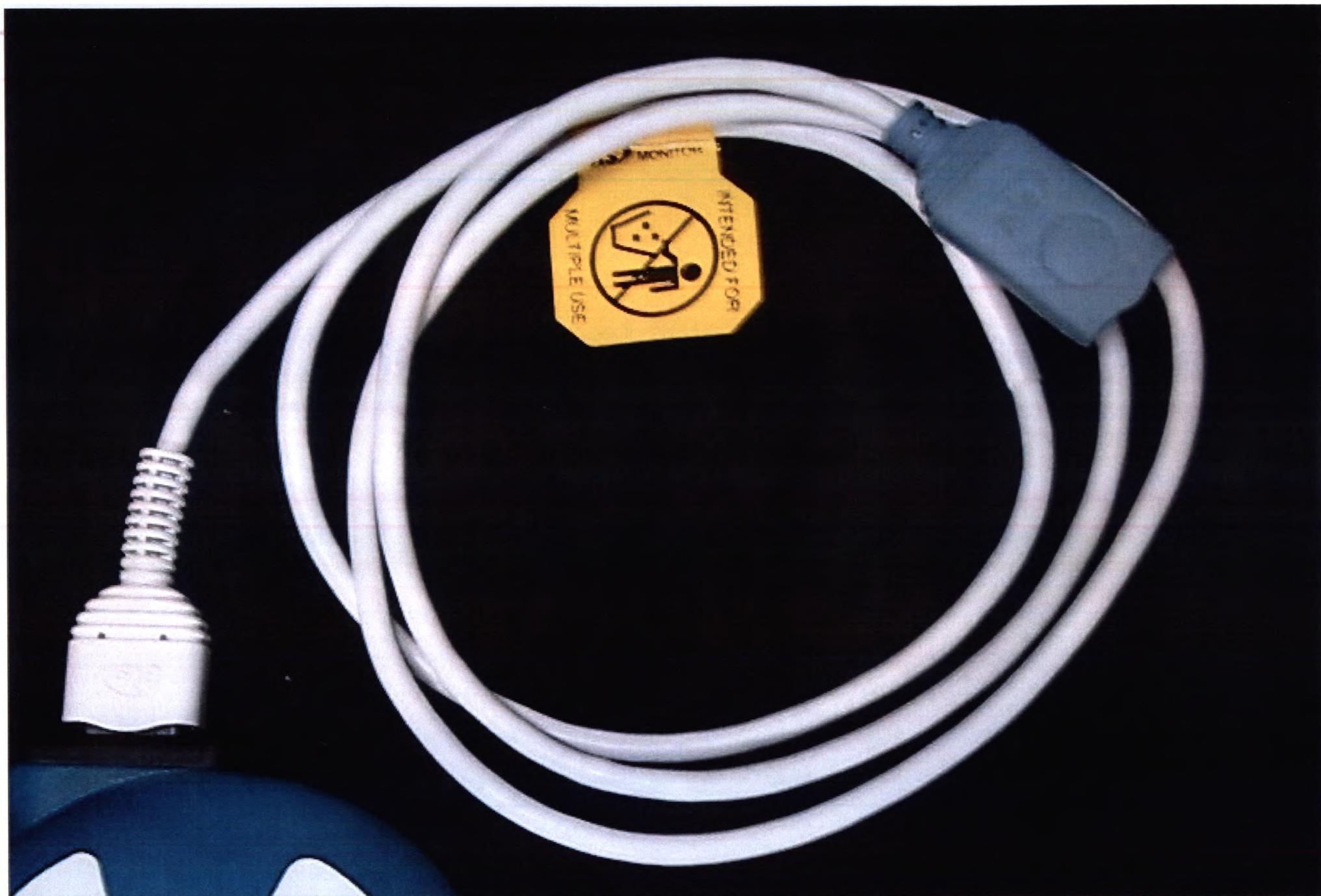
128. Кабель подключения датчика пациента к модулю биспектрального индекса (BIS).
