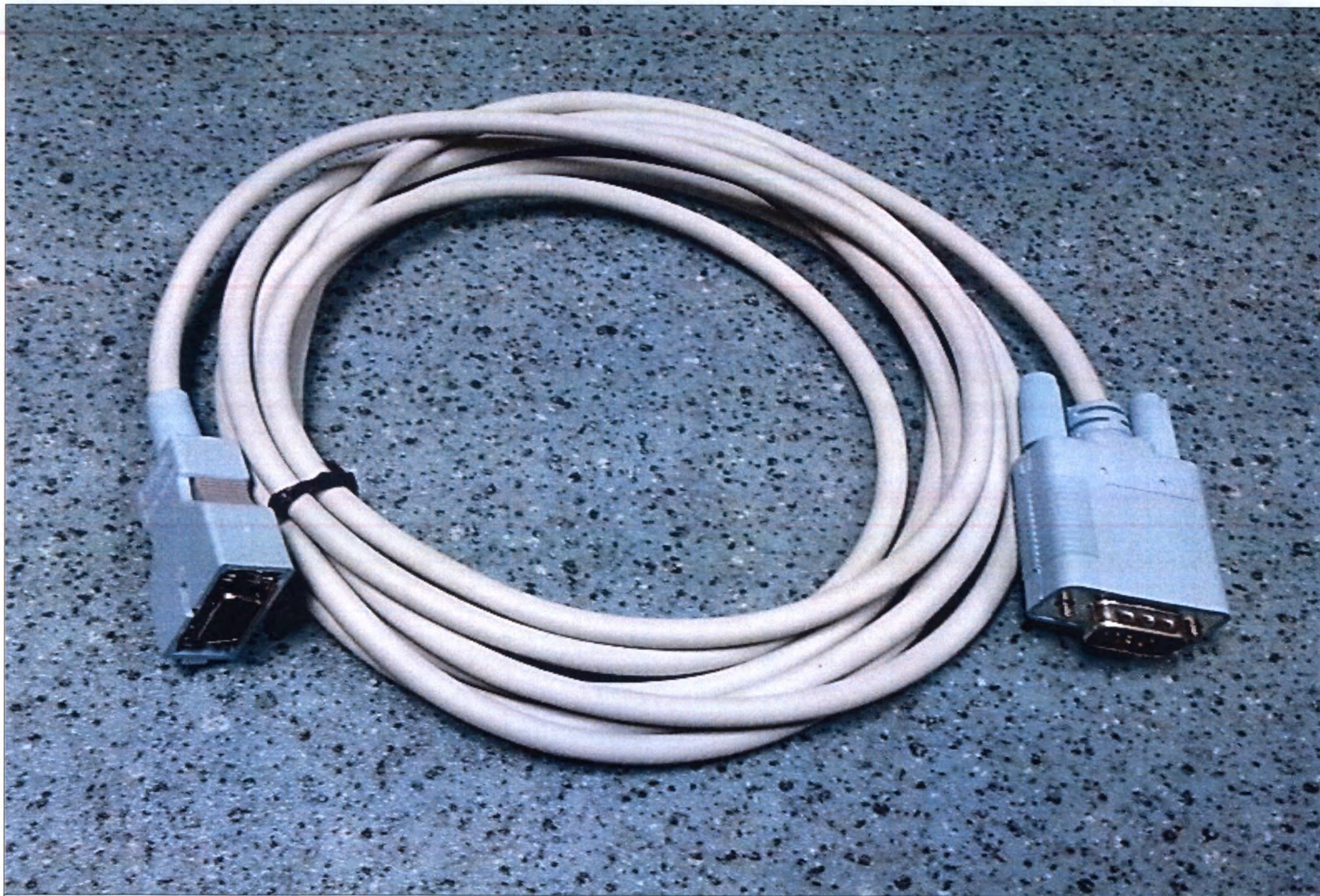
26. Видео-кабель подключения дисплея к монитору пациента.
