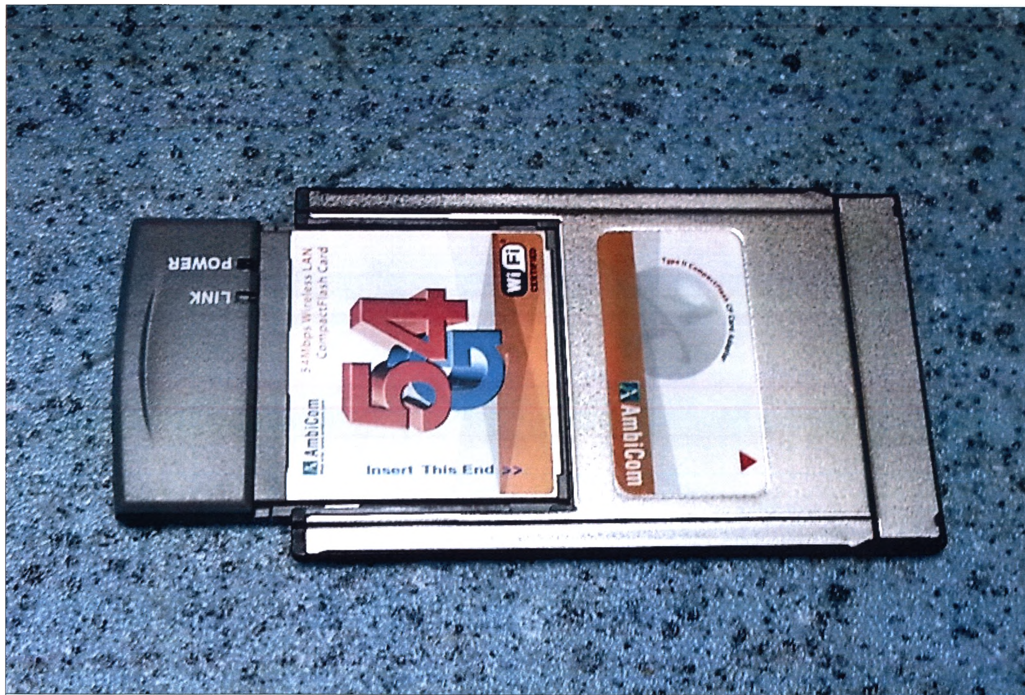
23. Модуль / адаптер монитора пациента для подключения к беспроводной информационной сети.
