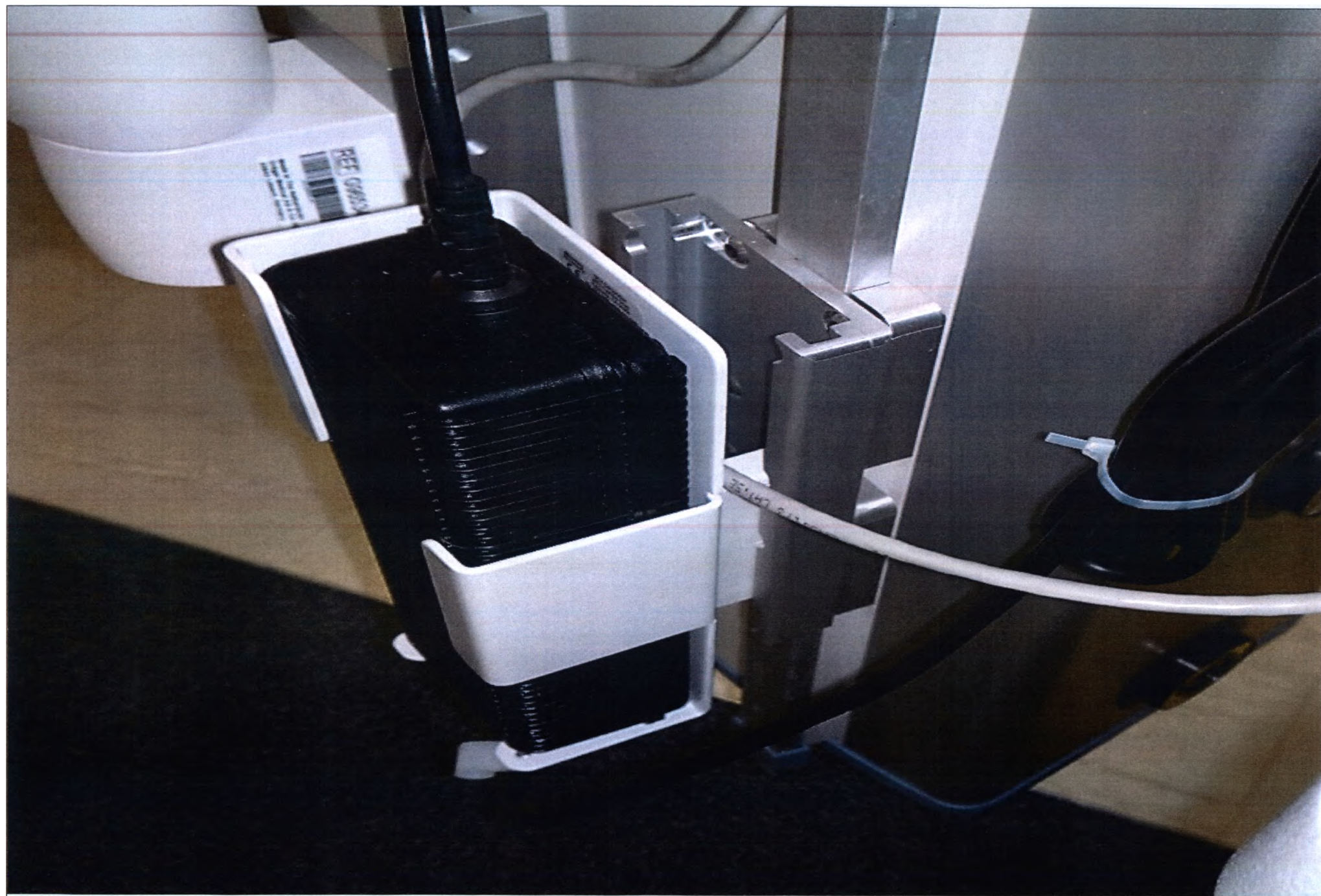
42. Кронштейн крепления блока питания дисплея / медицинского информационного терминала на вертикальный рельс.
