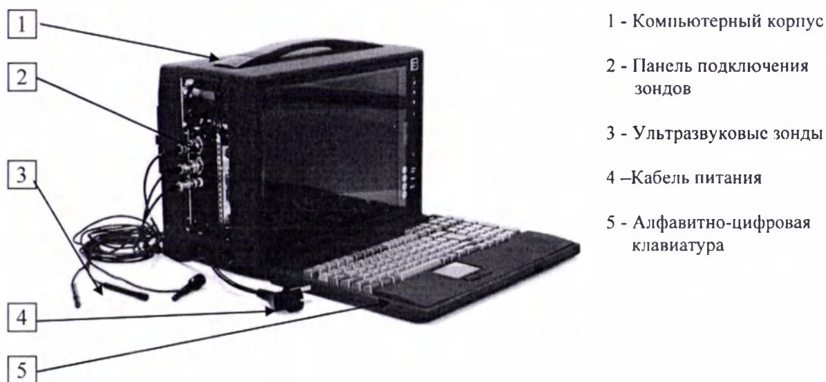
Рис 2.2 Переносной вариант со встроенным доплеровским модулем (варианты исполнения 1П, 2П)
