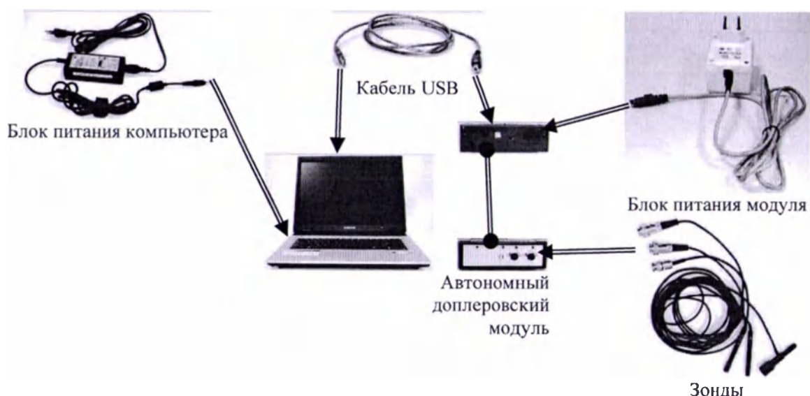
Рис 2.11 Внешний вариант в сборе с компьютером (варианты исполнения 1В, 2В)
