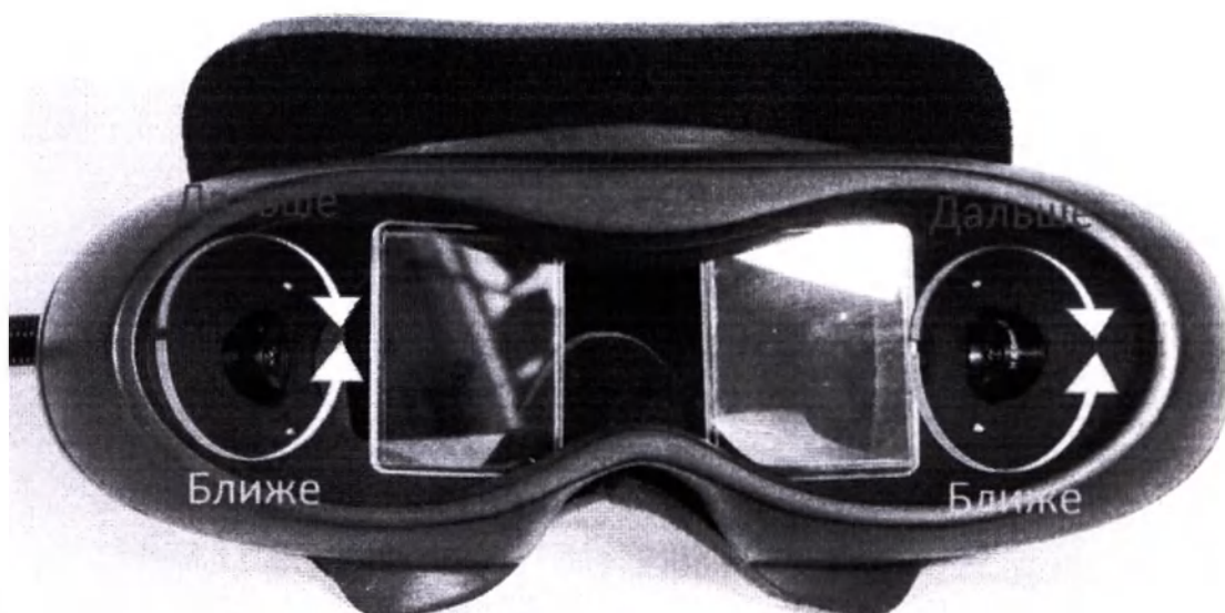
Рис. 10. Направление вращения объектива для удаления или приближения границ резко изображаемого пространства
