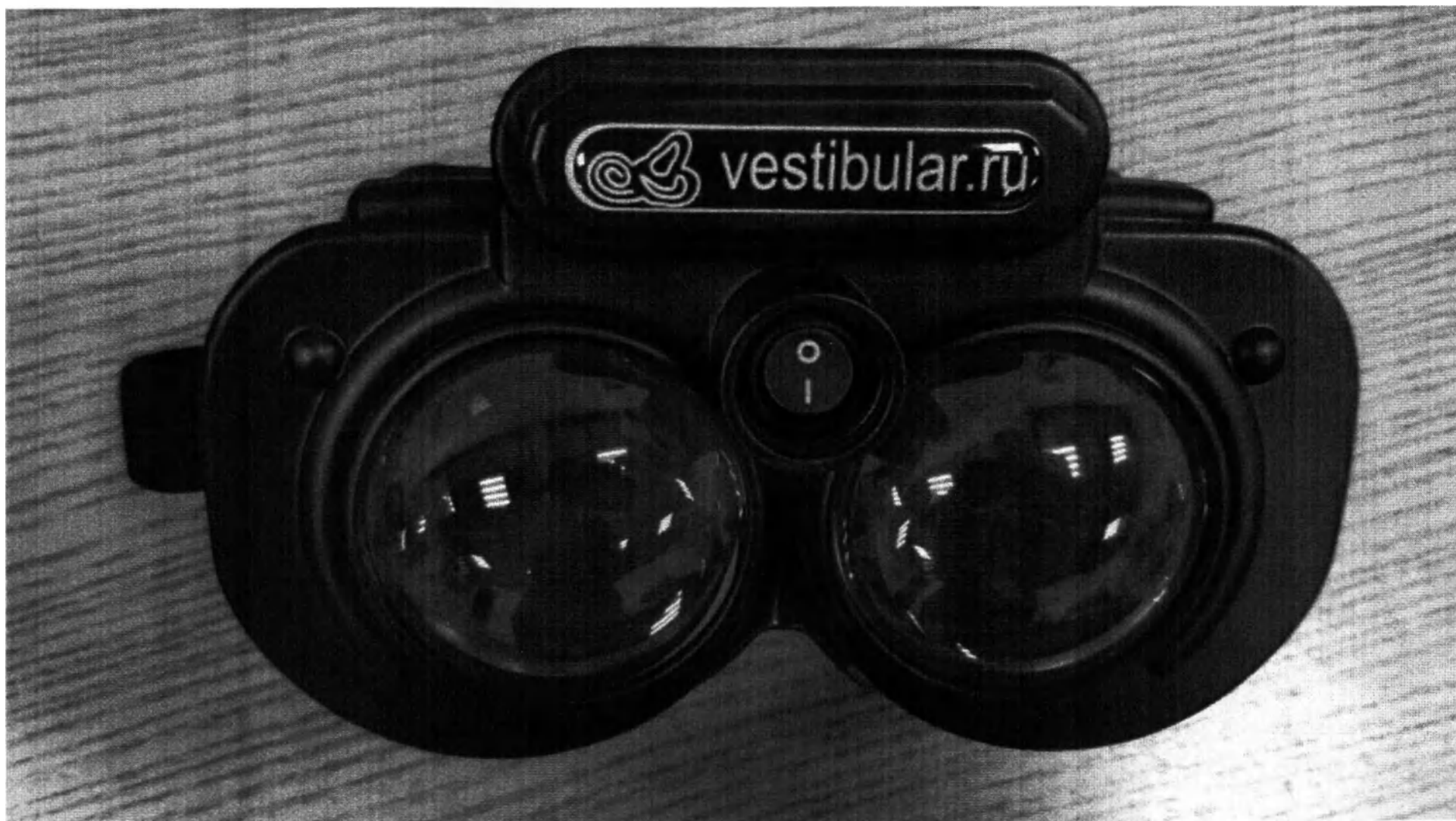
Очки со встроенными оптическими линзами и подсветкой глаз
