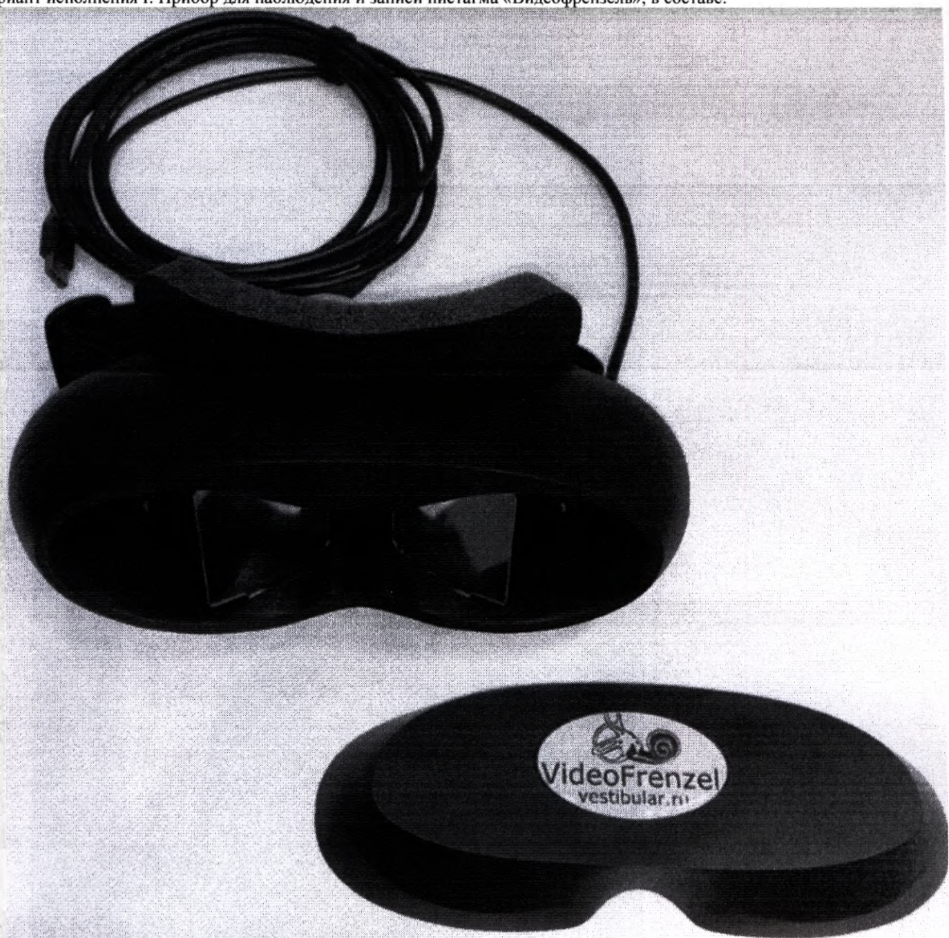
Очки со встроенными видеокамерами и затемняющей крышкой, общий вид
