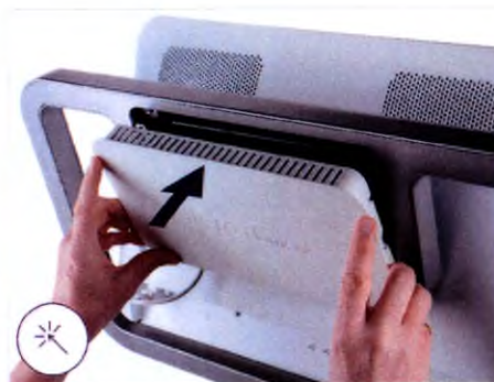
16. Прикрепите магнитную заднюю крышку
