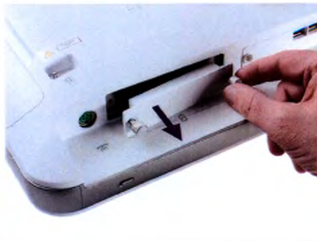
10. Снимите крышку отсека батареи питания
