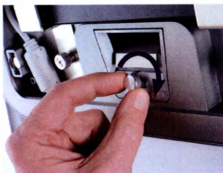
13. Поверните сканер и затяните винт с рифленной головкой, чтобы зафиксировать моноблок
