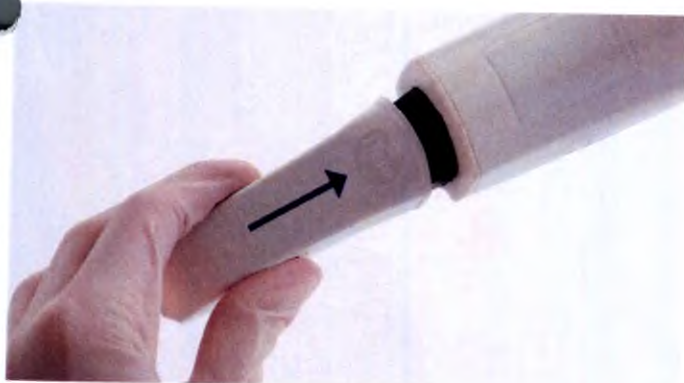
Шаг 3 Аккуратно надвиньте новый чехол на сканирующее устройство до щелчка.
