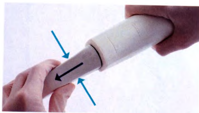
Шаг 2 Слегка надавите на обе стороны чехла, медленно извлеките его из сканирующего устройства и выбросьте.
