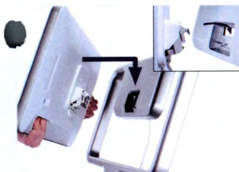
12. Поднимите моноблок, чтобы закрепить его
