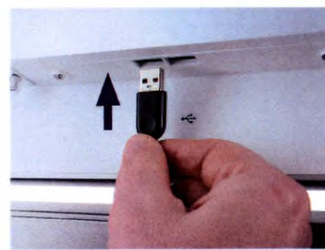
23. Подключите веб-камеру к USB-порту в нижней части моноблока
