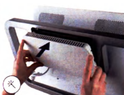
16. Прикрепите магнитную заднюю крышку
