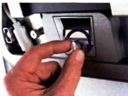
13. Поверните сканер и затяните винт с рифленной головкой, чтобы зафиксировать HD-экран
