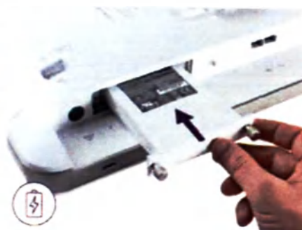
11. Вставьте элемент питания в отсек для элементов питания и затяните винты с рифленной головкой
