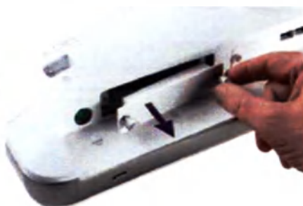
10. Снимите крышку отсека элементов питания
