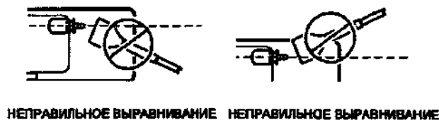
Рис. 14. Подсоединение беспроводного коннектора помпы к помпе SynchroMed EL (вид сбоку).
