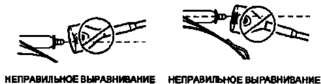
Рис. 13. Подсоединение беспроводного коннектора помпы к помпе SynchroMed II (вид сверху).
