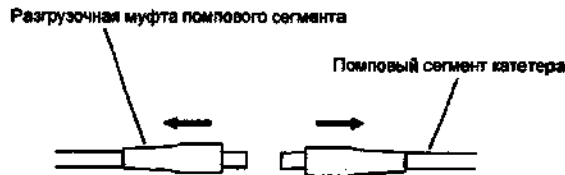
Рис. 7. Установка прозрачной разгрузочной муфты на помповый сегмент.
