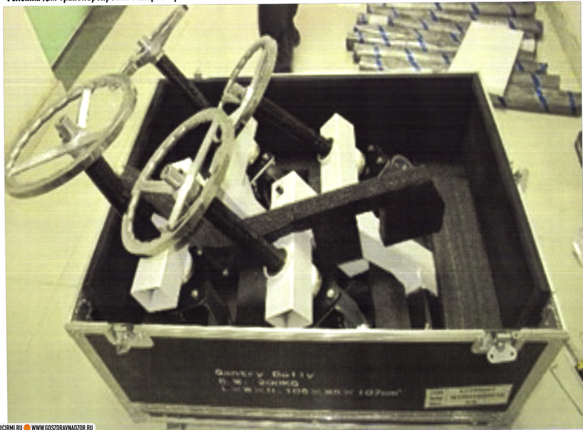
Тележка для транспортировки Гантри. серия 12105021
