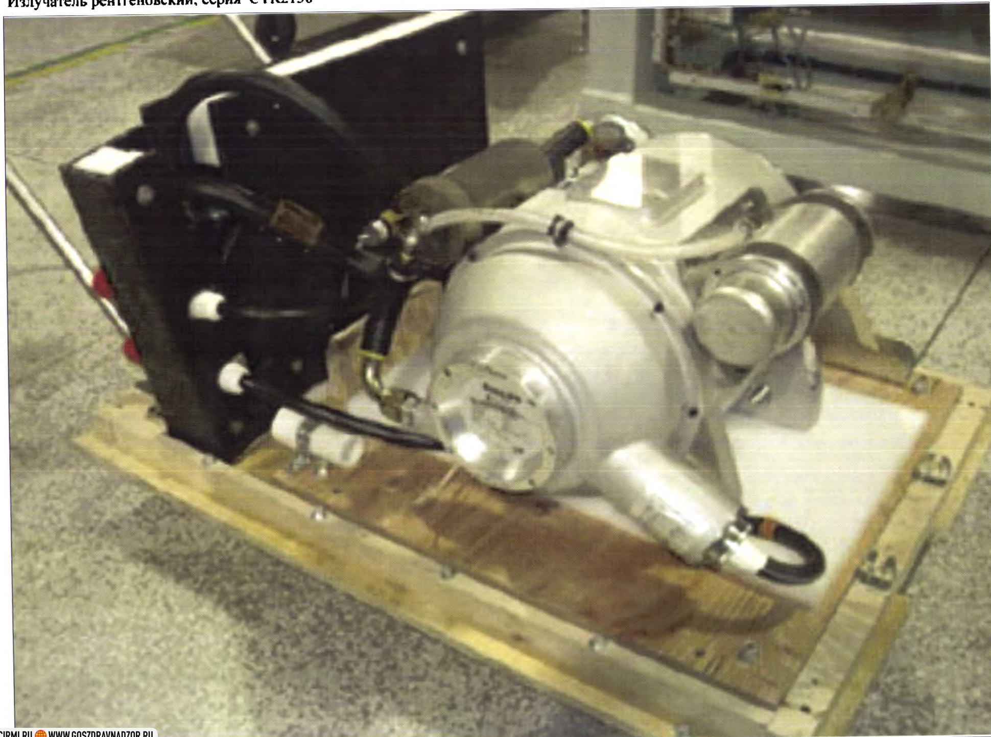
Излучатель рентгеновский, серия CTR2150
