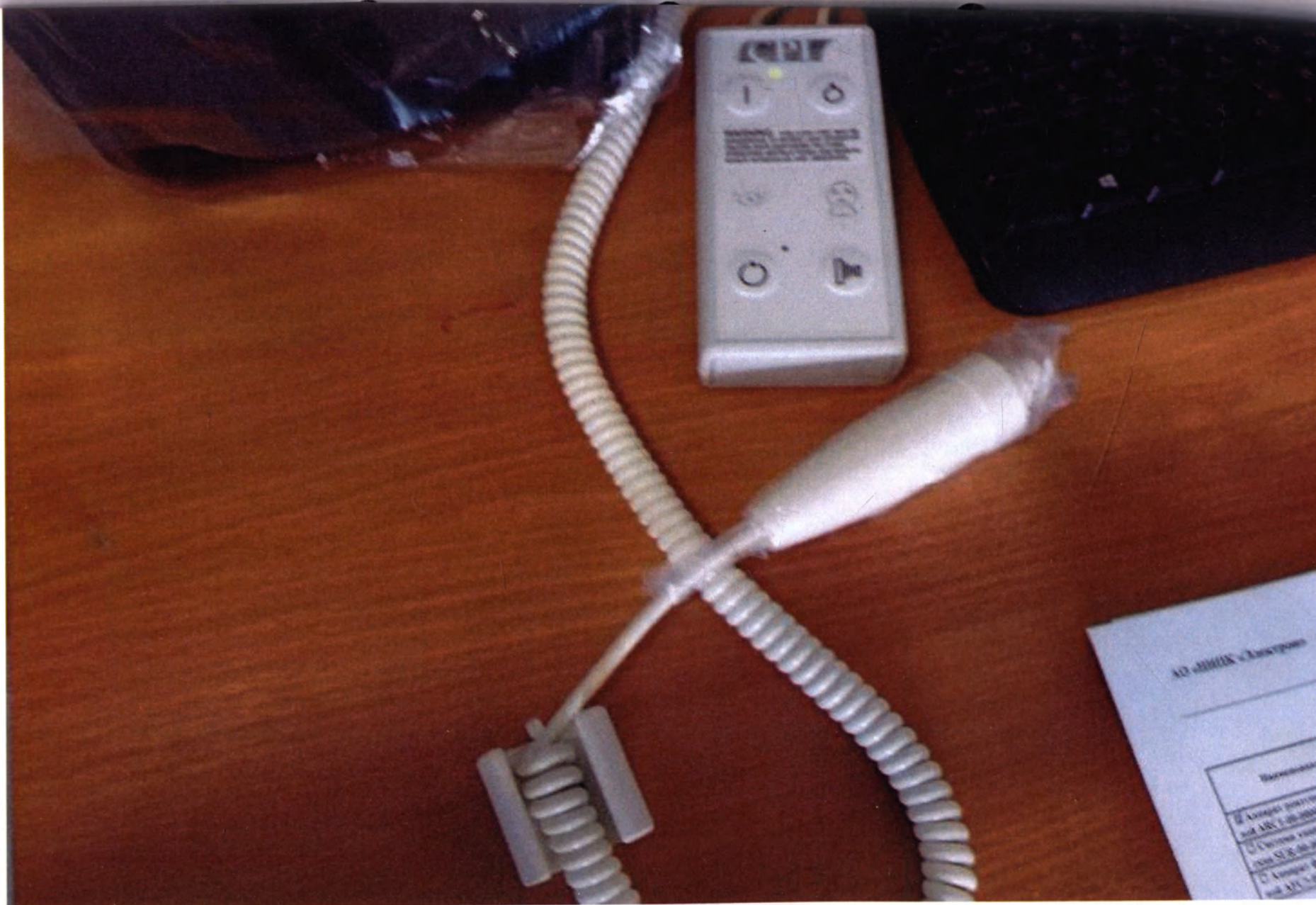
Фотография 26 – Пульт РПУ-ОКО (как правило, располагается на рабочем столе АРМ1) ТУ 9442-022-11150760-2006, РУ № ФСР 2010/09310, АО «НИПК «Электрон»
