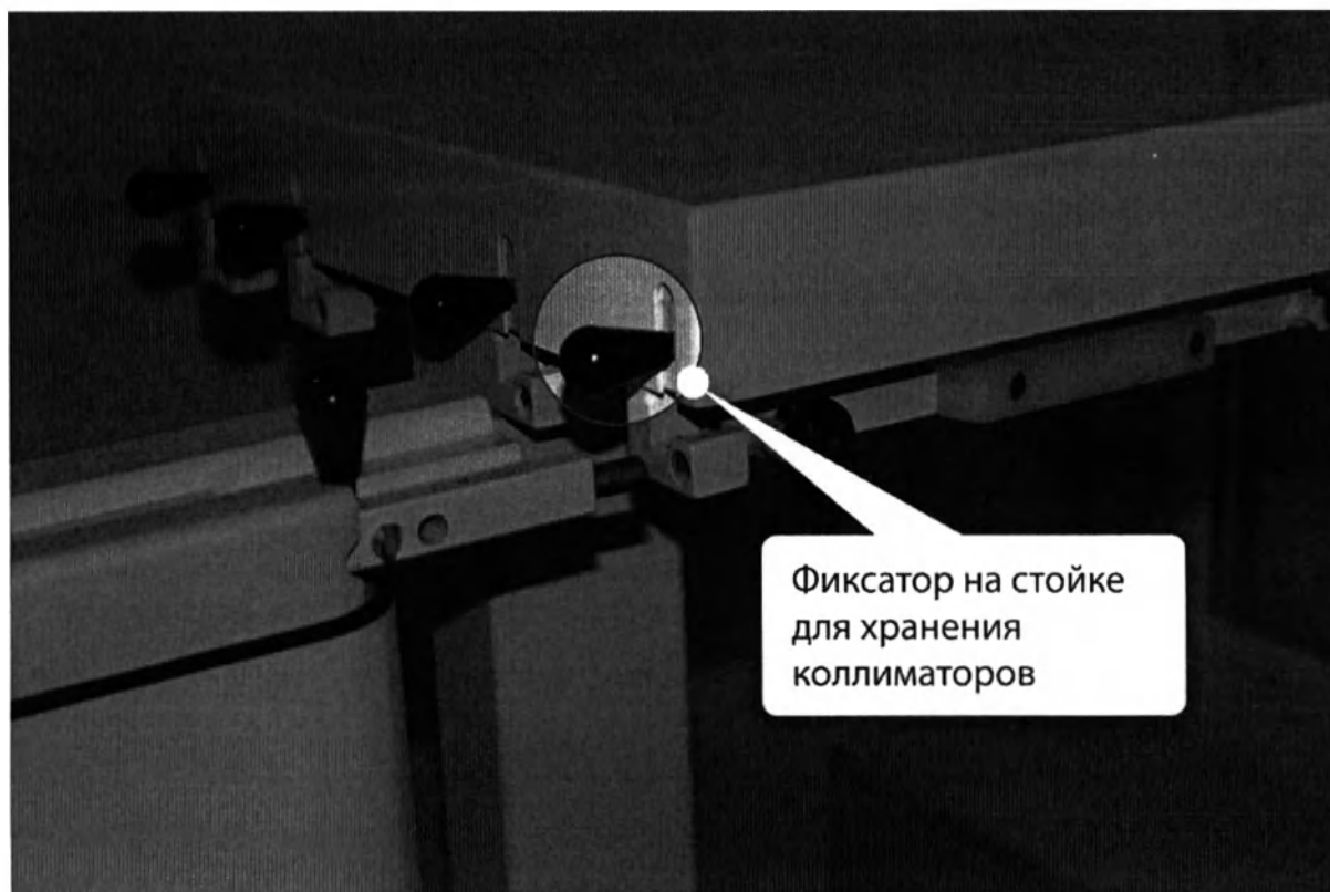
Рисунок 8-2 — Фиксатор на стойке для хранения коллиматоров
