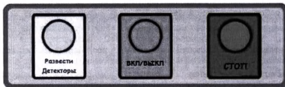
Рисунок 5-1 — Положение кнопки ВКЛ/ВЫКЛ на панели управления гантри
