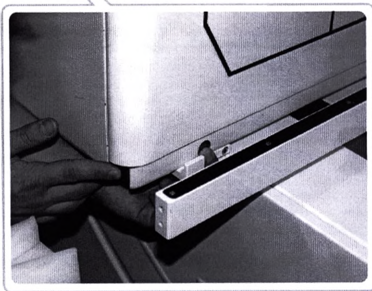
Рисунок 8-10 — Освобождение коллиматора от детектора
