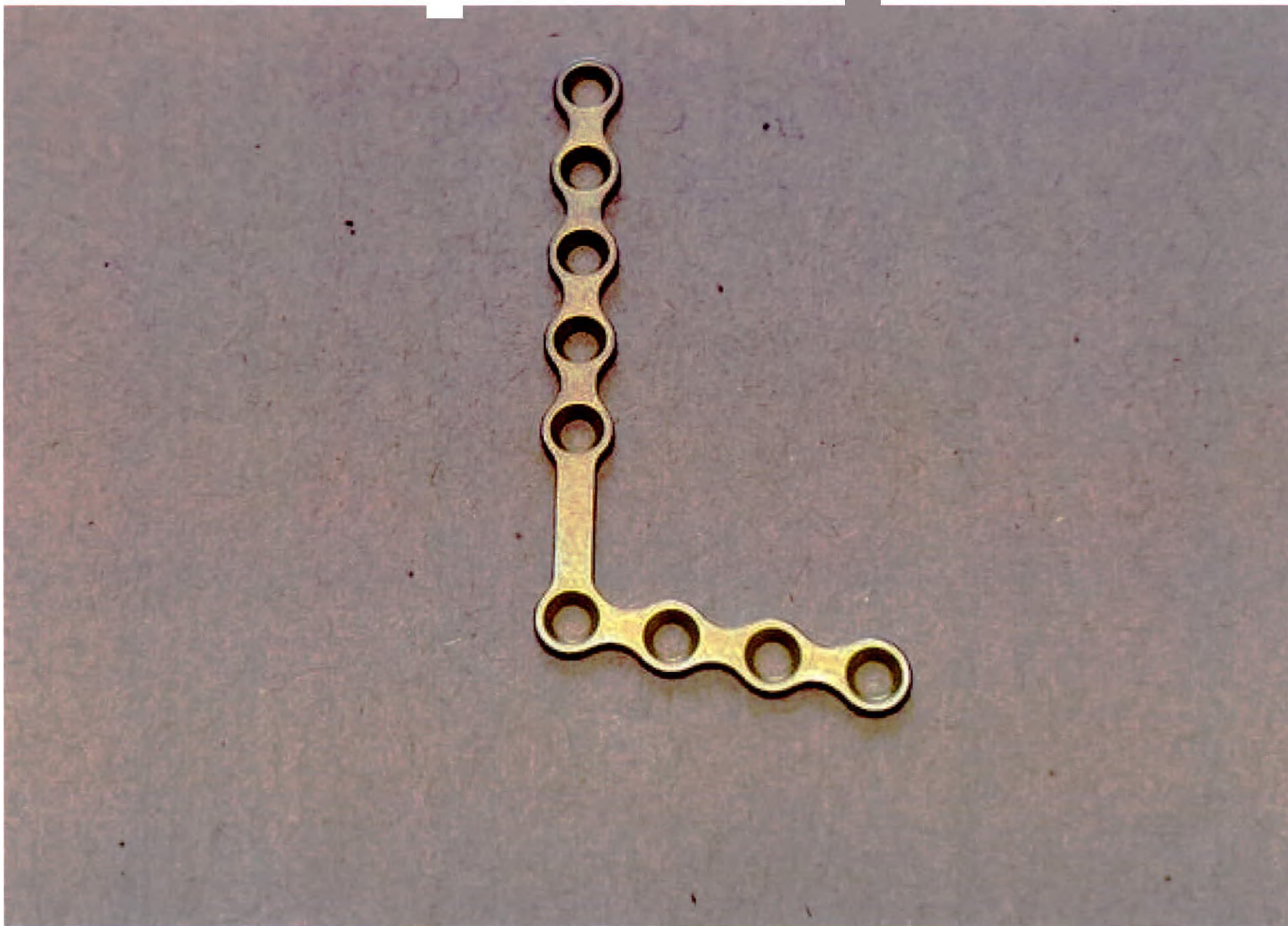
Мини-пластина L-образная правая, под углом 100°, 9 отверстий, планка 12 мм, 0,75 мм х 2,0 мм
