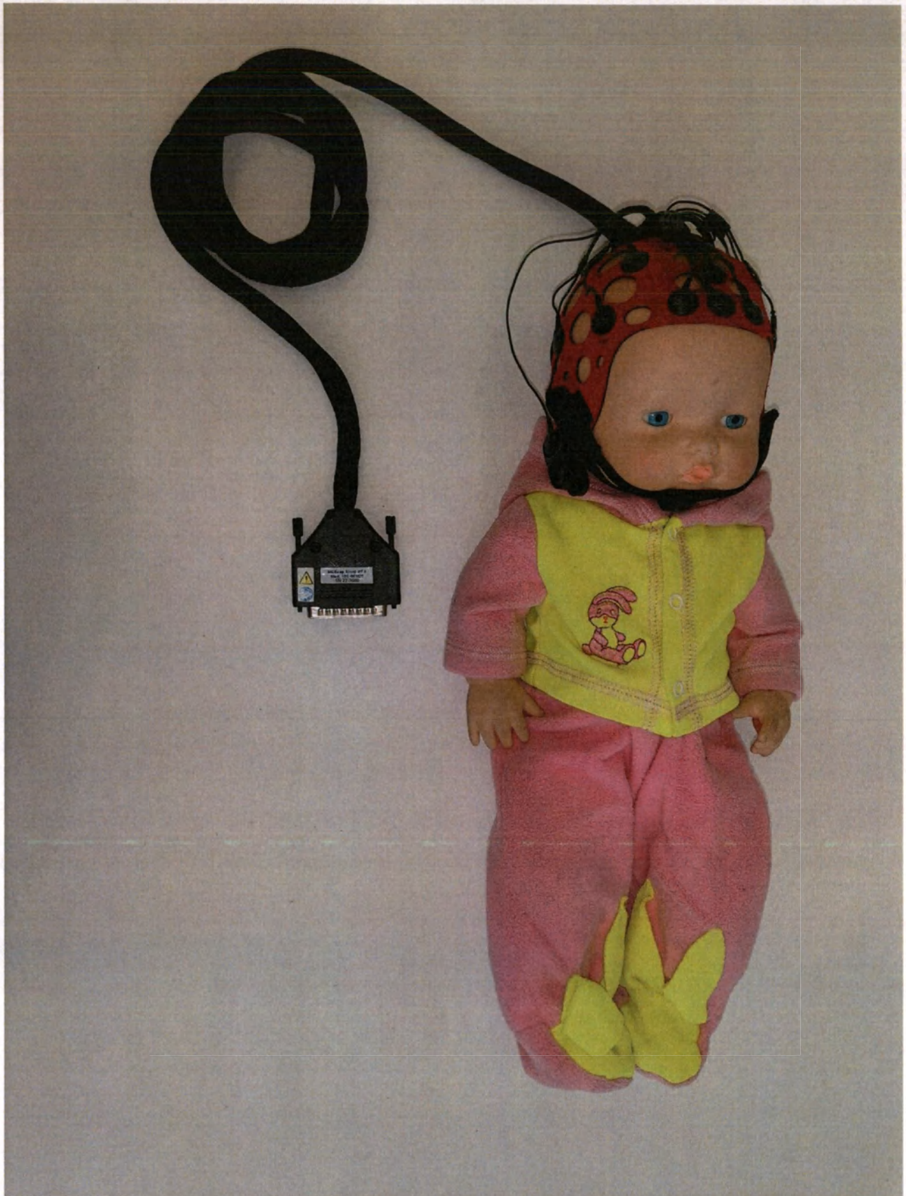
Рисунок 10.1 Шлем электродный SLEEP размера Inf II с ушными фиксаторами – общий вид Примечание – в модели изделия представлен тип разъема DB25M, тип электрода MCScap-T
