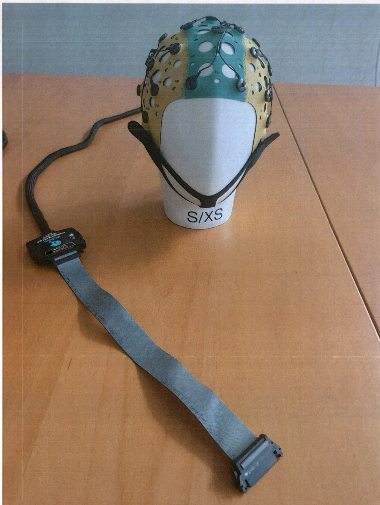
Рисунок 7.1 Шлем электродный PROFESSIONAL KEL40F размера S/XS – общий вид Примечание – в модели изделия представлен тип разъема KEL40F, тип электрода MCScap-NTC
