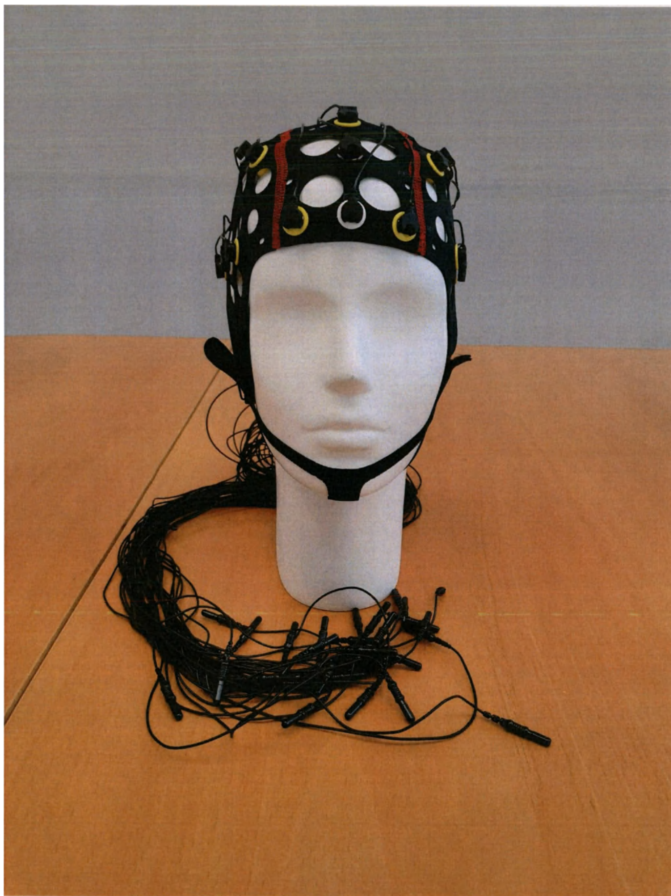
Рисунок 13.1 Шлем электродный ELECTRODE SET-36 размера М – общий вид Примечание – в модели изделия представлен тип разъема Touchproof, тип электрода MCScar-E
