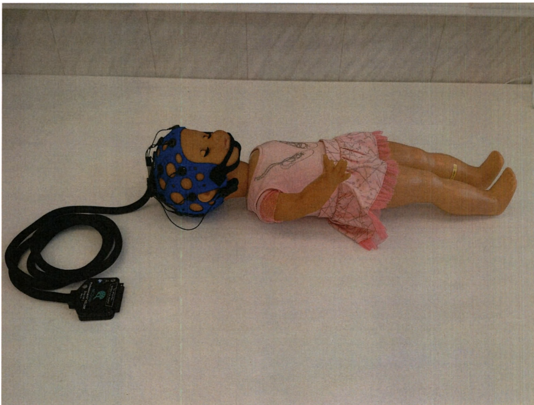
Рисунок 9.1 Шлем электродный PROFESSIONAL-NT KEL50F размера Inf I с ушными фиксаторами – общий вид
