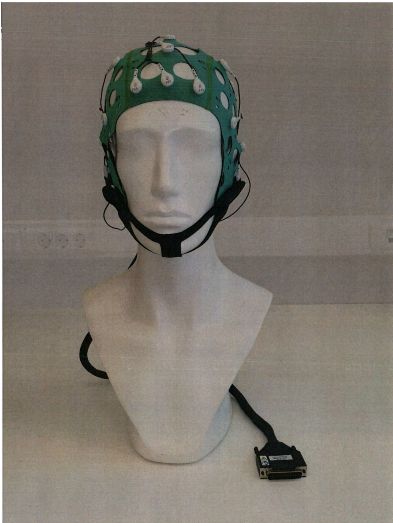
Рисунок 1.1 Шлем электродный CLINIC размера XL с ушными фиксаторами – общий вид Примечание – в модели изделия представлен тип разъема DB-25M, тип электрода MCScap-C
