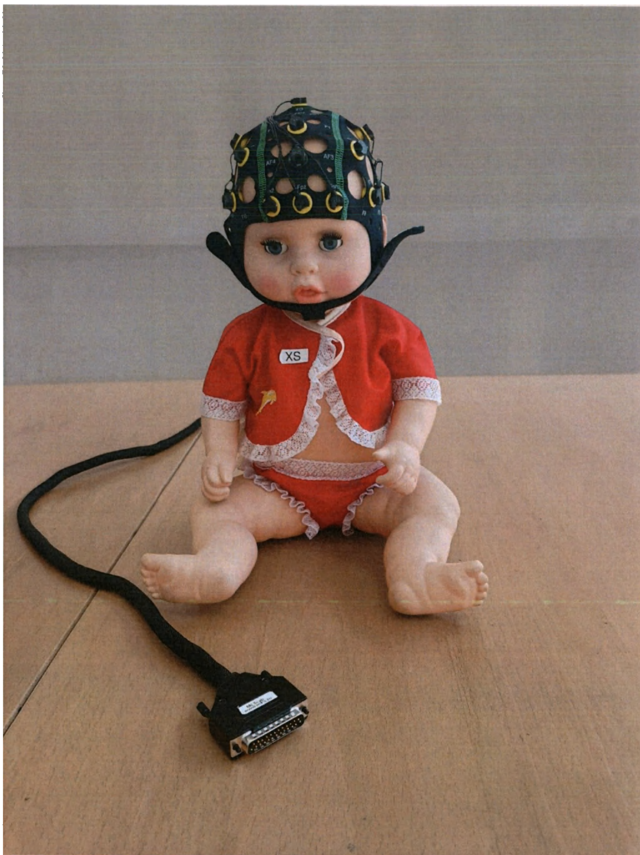
Рисунок 8.1 Шлем электродный BASE размера XS – общий вид Примечание – в модели изделия представлен тип разъема DB25M, тип электрода MCScar-E
