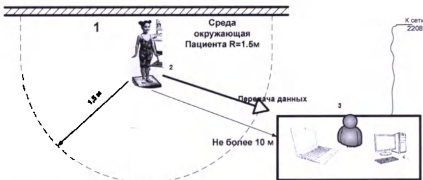
Рисунок 6.2 Расположение элементов комплекса при беспроводной связи, когда в среде, окружающей пациента, находится только стабилметрическая платформа.
