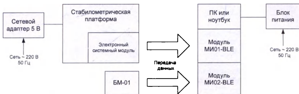
Рисунок 5.1б. Блок-схема комплекса при использовании блока питания/сетевого адаптера 5В и модуля интерфейсного МИ01- BLE
