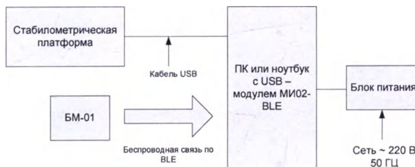
Рисунок 5.1а. Блок-схема комплекса при использовании кабеля USB A-B
