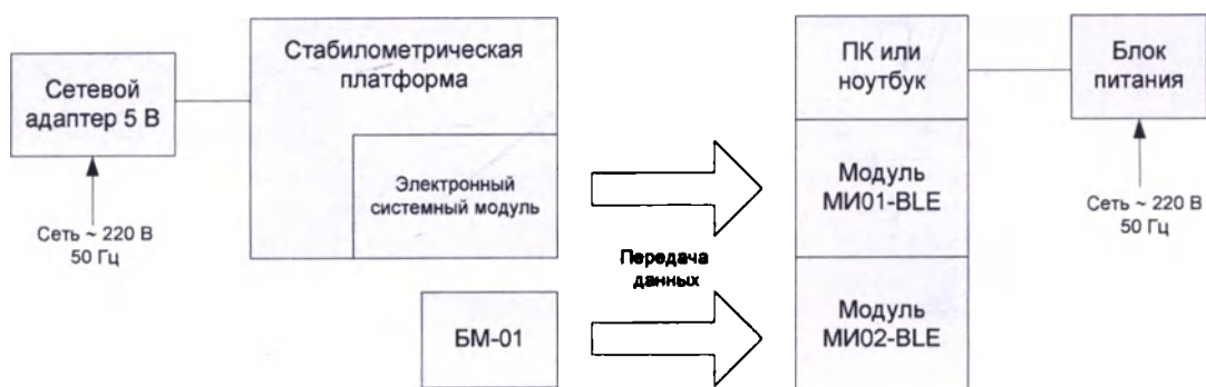
Рисунок 5.1б. Блок-схема комплекса при использовании блока питания/сетевого адаптера 5В и модуля интерфейсного (адаптера Bluetooth Low Energy) МИ01- BLE.
