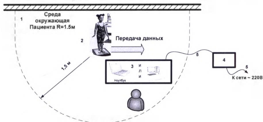
Рисунок 6.3 Расположение и состав элементов комплекса при проводной связи через USB кабель, с использованием стационарного компьютера или ноутбука.
