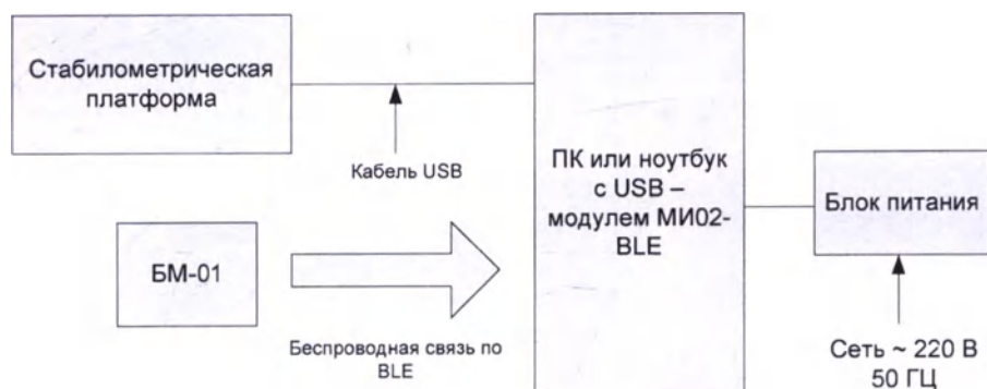
Рисунок 5.1а. Блок-схема комплекса при использовании кабеля USB A-B.
