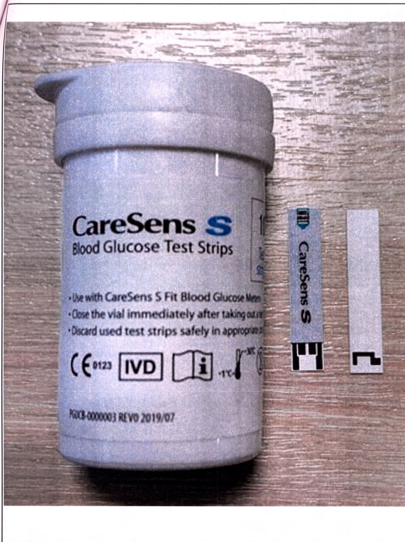
Фото 2. Тест-полоски CareSens S для количественного определения глюкозы в образце цельной крови для системы мониторинга CareSens S Fit
