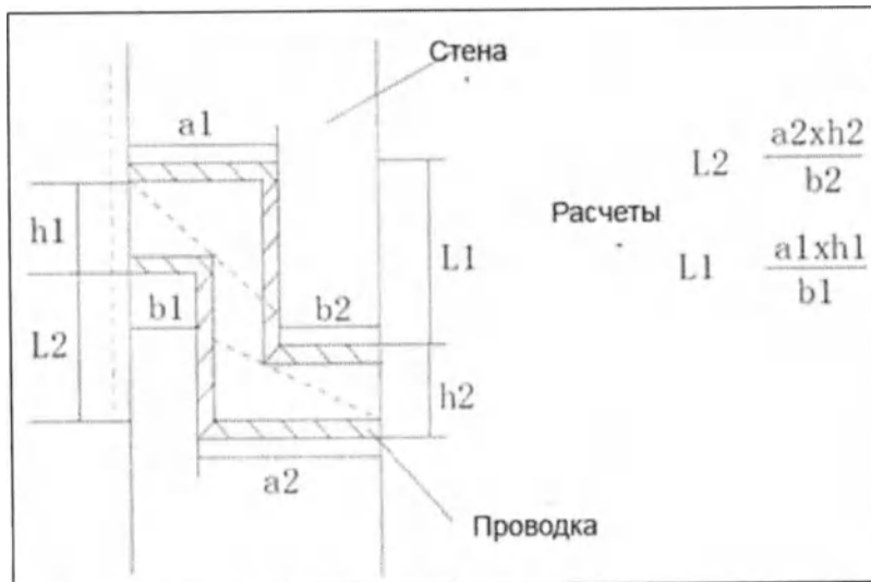
Рисунок 3 Метод S-формы свинцовой изоляции
