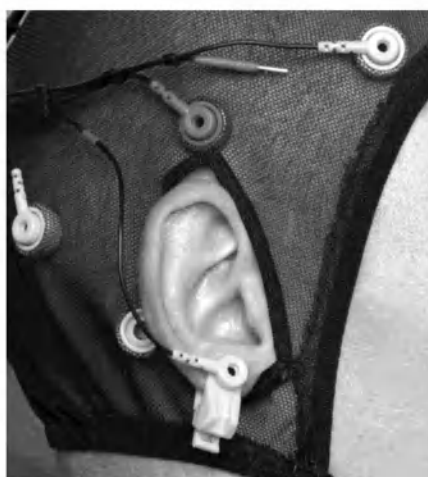
Рисунок 10 – Ухо с клипсой, в которую вставлен референтный электрод
