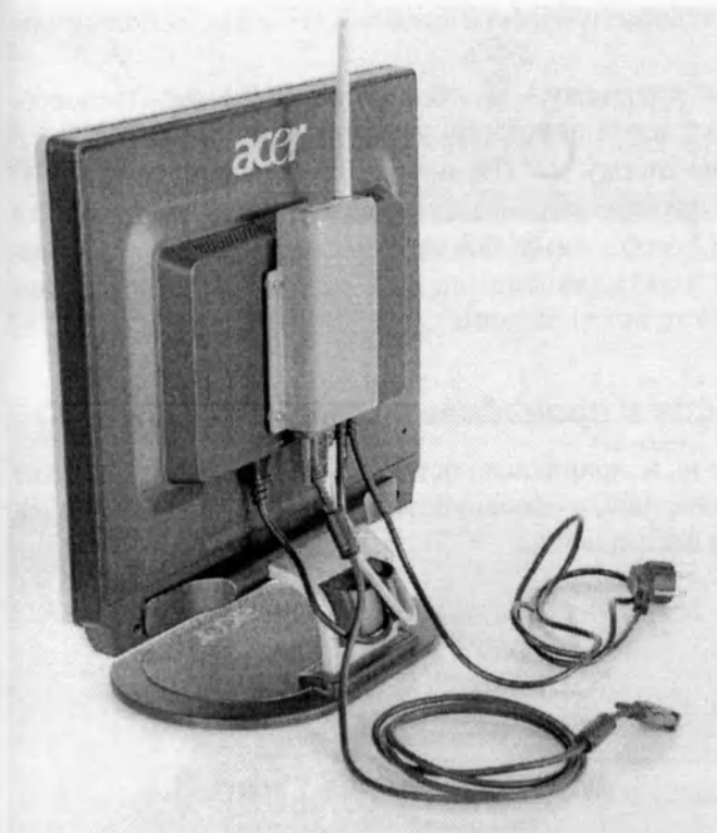
Рисунок 5 – Монтаж ГШП-04 на мониторе с помощью крепления «VESA-100»
