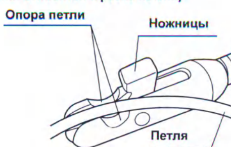
(b) Неправильное положение (петля расположена только на одной кромке опоры петли)
