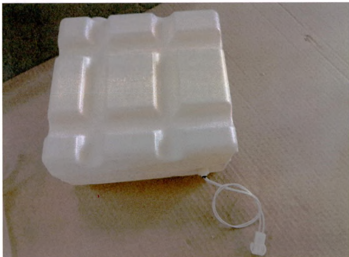
Фото 155. Резервуар для моющего раствора
