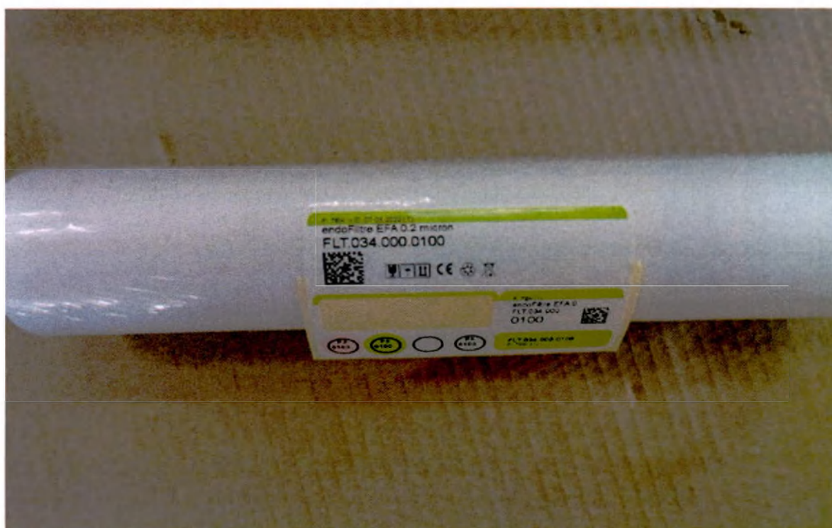
Фото 106. Фильтр очистки воды 0,2 микрон
