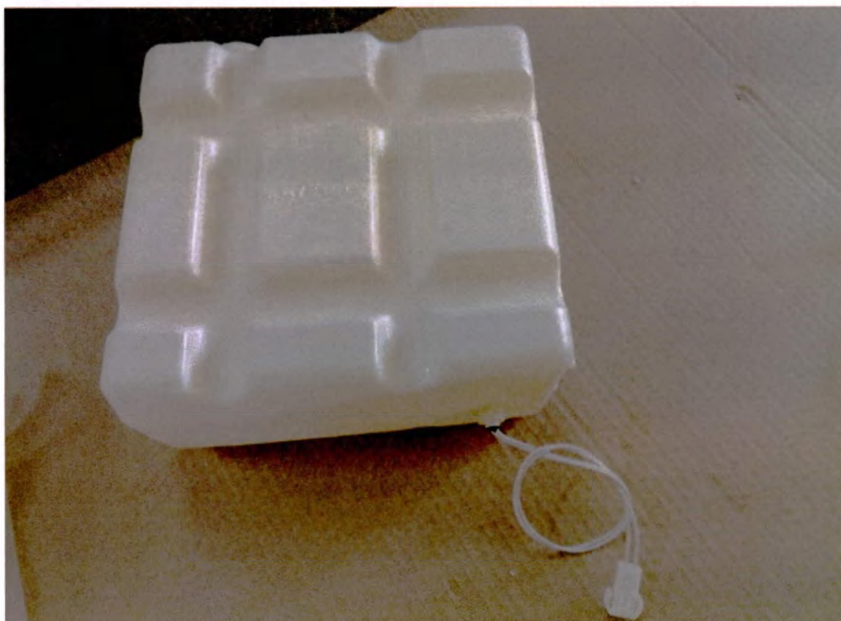
Фото 92. Резервуар для моющего раствора
