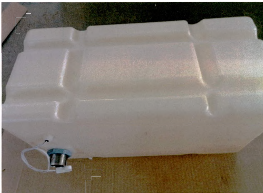
Фото 154. Резервуар для дезинфицирующего средства
