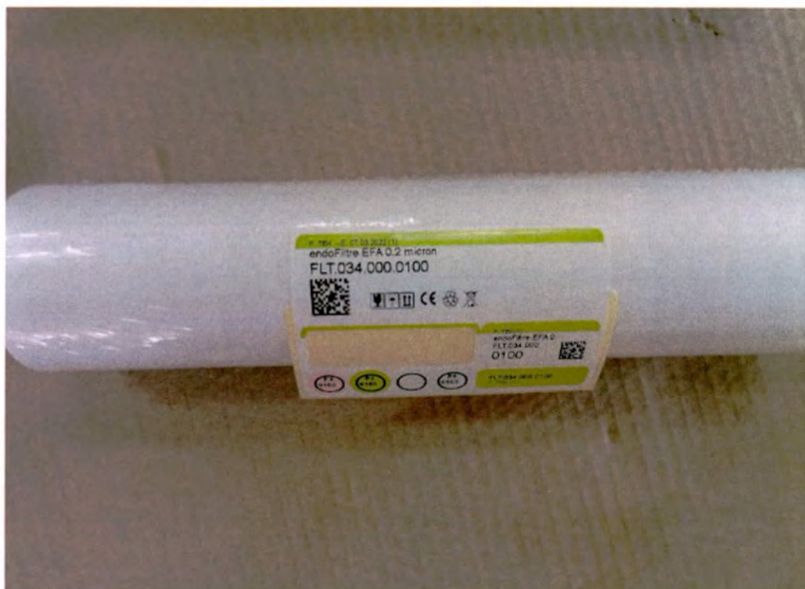
Фото 43. Фильтр очистки воды 0,2 микрон
