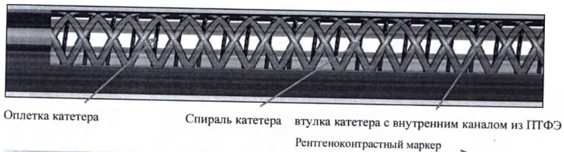
Рис. 3а – Увеличенное изображение конструкции микрокатетера VIA
