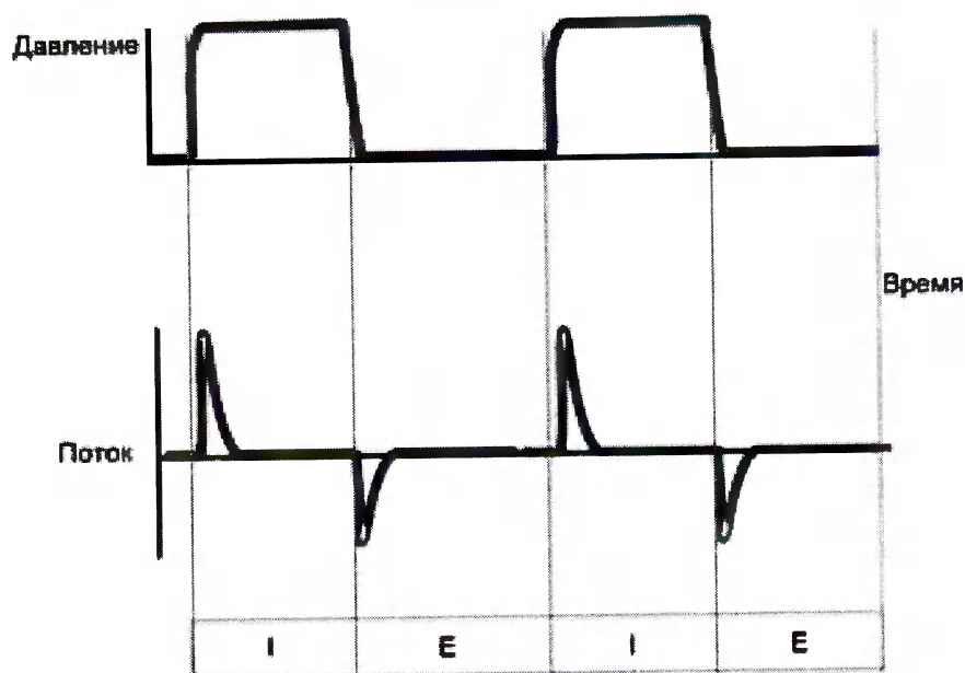
Рисунок В-1. Традиционная вентиляция с управлением по давлению у пассивного пациента (без спонтанного дыхания). Поток к пациенту на вдохе (I); поток от пациента на выдохе (E).
