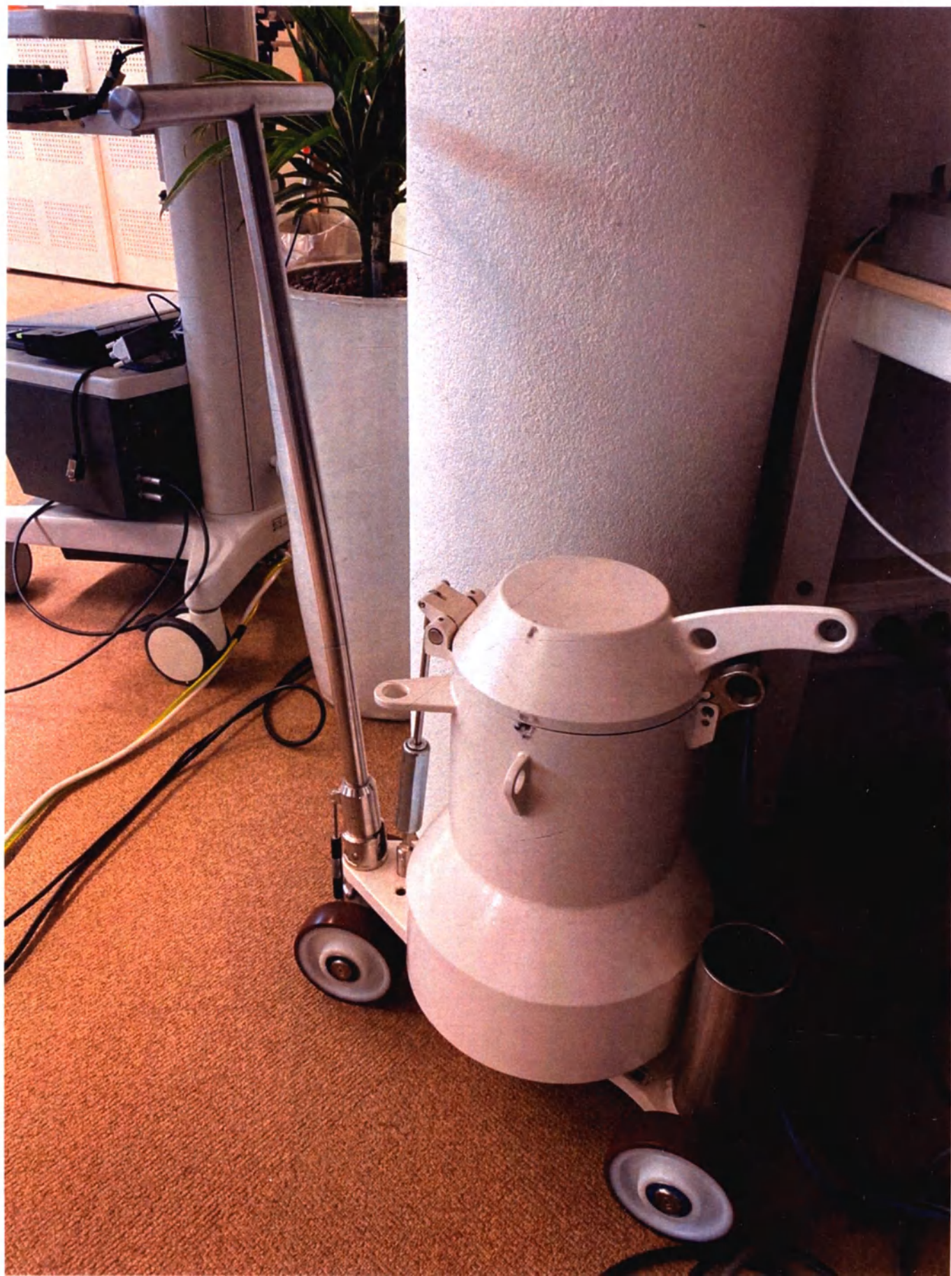
Защитный (транспортный и аварийный) контейнер для источника Flexisource Cobalt-60 (136520)
