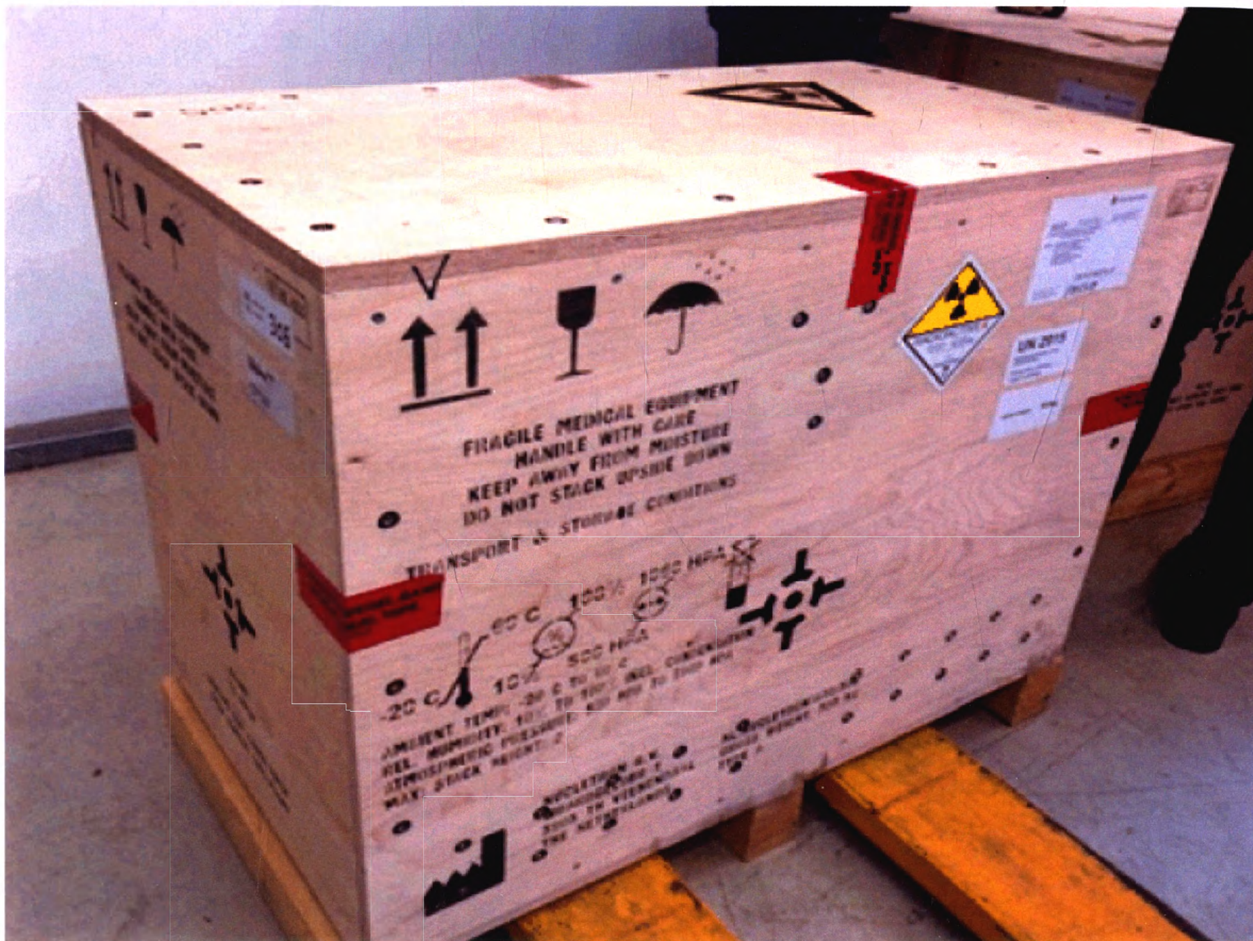
Ящик для транспортировки источника Flexisource Cobalt-60 (136630)
