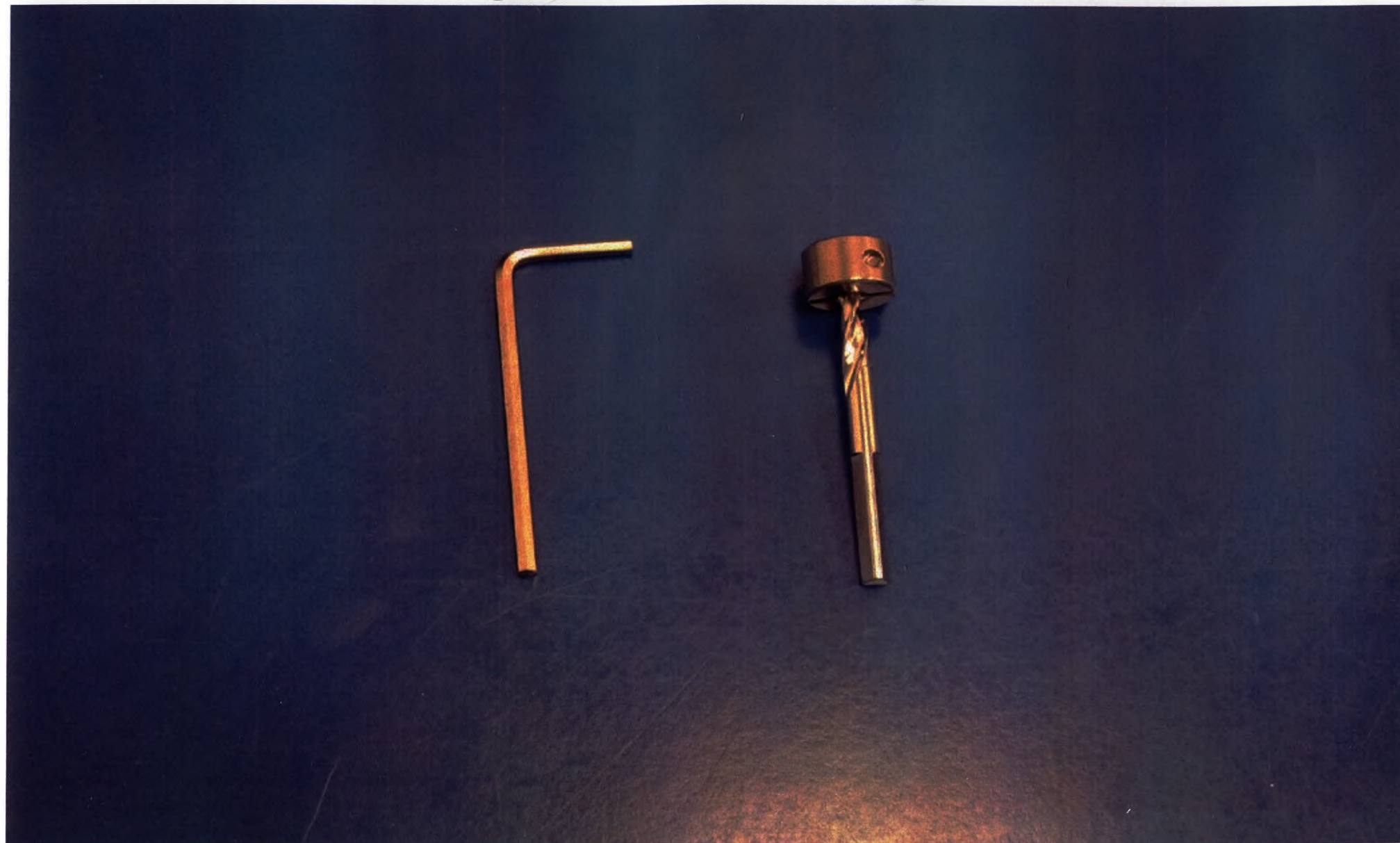
Фреза диаметром 3,97 мм (5/32 дюйма).
