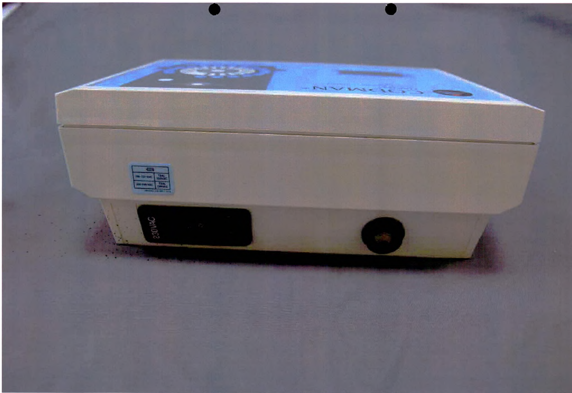
Программатор. Задняя панель с разъемами питания и подключения трансмиттера.
