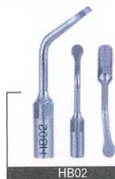
HB02 Насадка остеопластический круг Операционная длина: 12,5мм±1% Ширина: 4,0мм±1% Толщина: 1мм±1% Масса: 1,6г±1%
