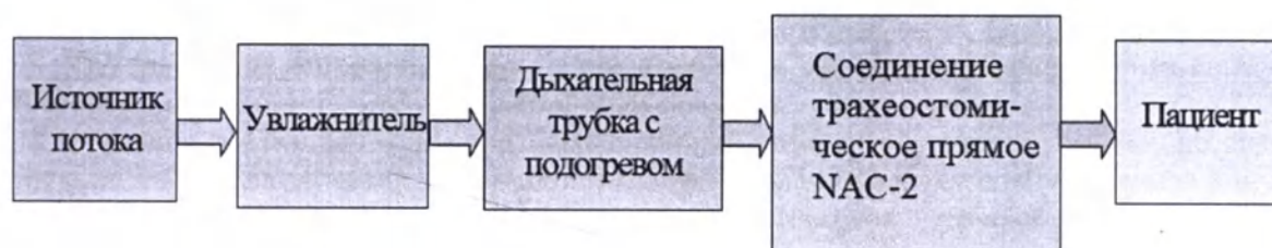
Рисунок 3.2 Механизм обеспечения высокопоточной кислородной терапии с увлажнением кислородно-воздушной смеси
