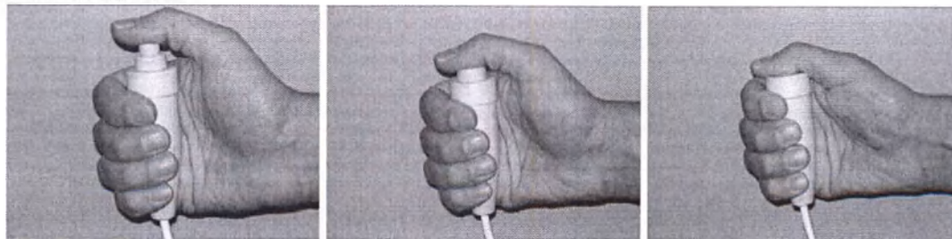
Рисунок 16. Ручной переключатель экспозиции: REST(выкл), PREPARATION(подготовка), EXPOSIZION(экспозиция)
