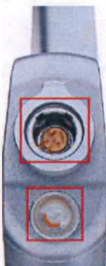
Тип дефекта: неисправное гнездо, поврежденная многофункциональная кнопка
