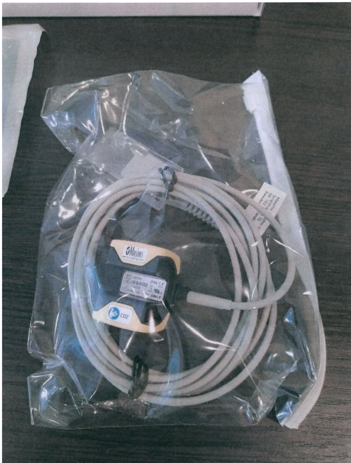
Рисунок 4 - Датчик капнографии модель «IRMA», производства «Masimo», Швеция (поставляется при необходимости)
