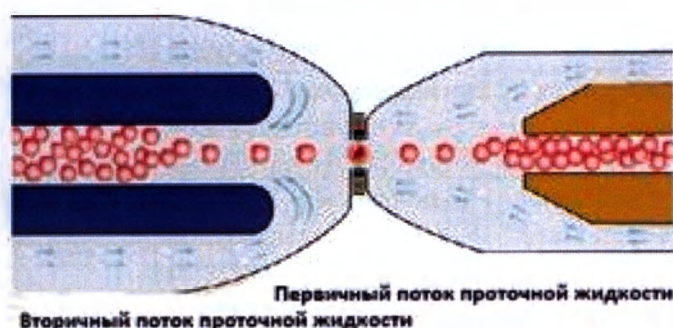
Рисунок 4. Метод импеданса проточной жидкости
