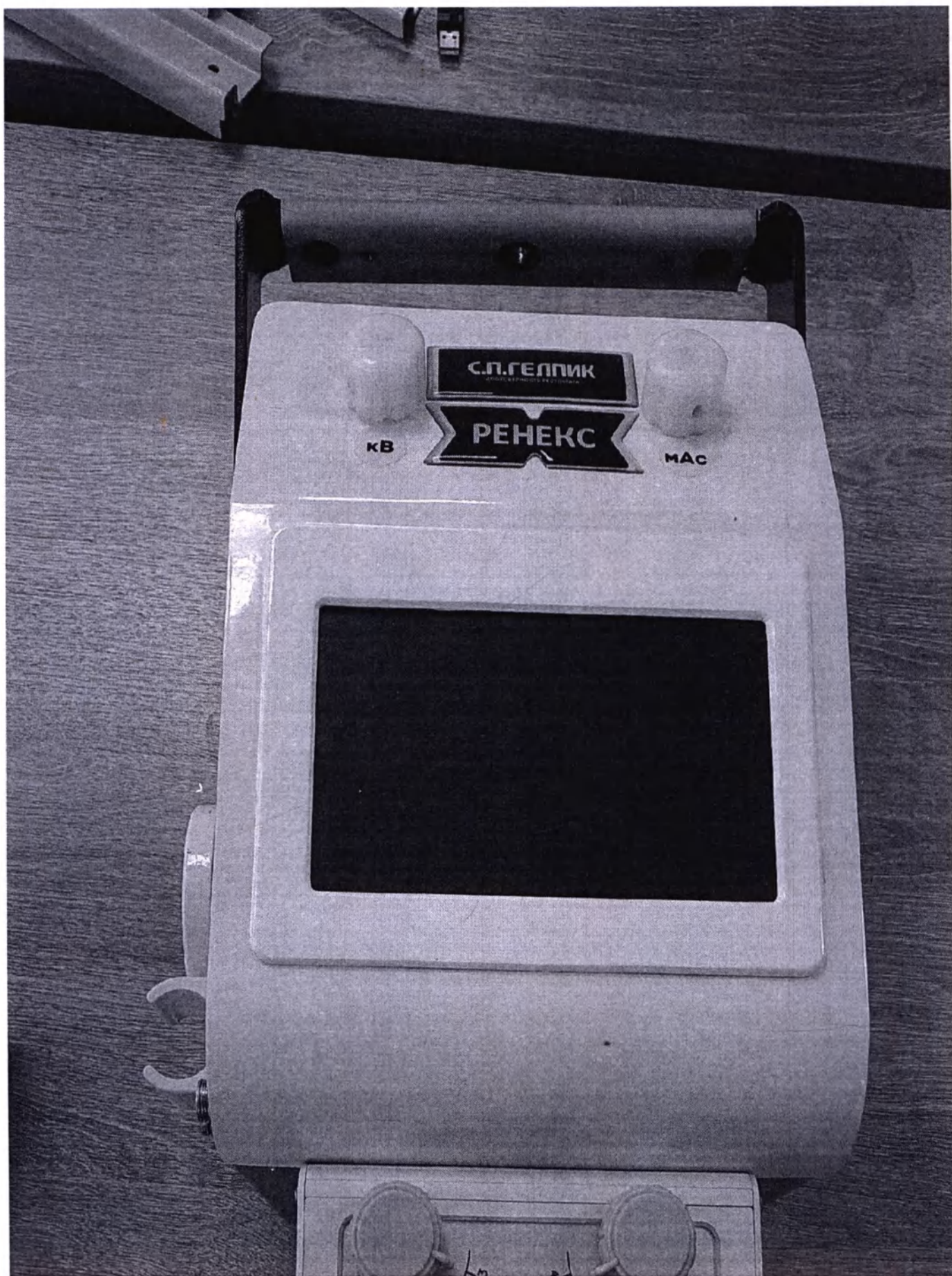
- Рентгеновский излучатель моноблочного типа ЛЖКМ.433251.001, производства ООО «С.П.ГЕЛПИК», Россия, с трубкой рентгеновской 1,1-5,ЗБДМ41-125, производства АО
