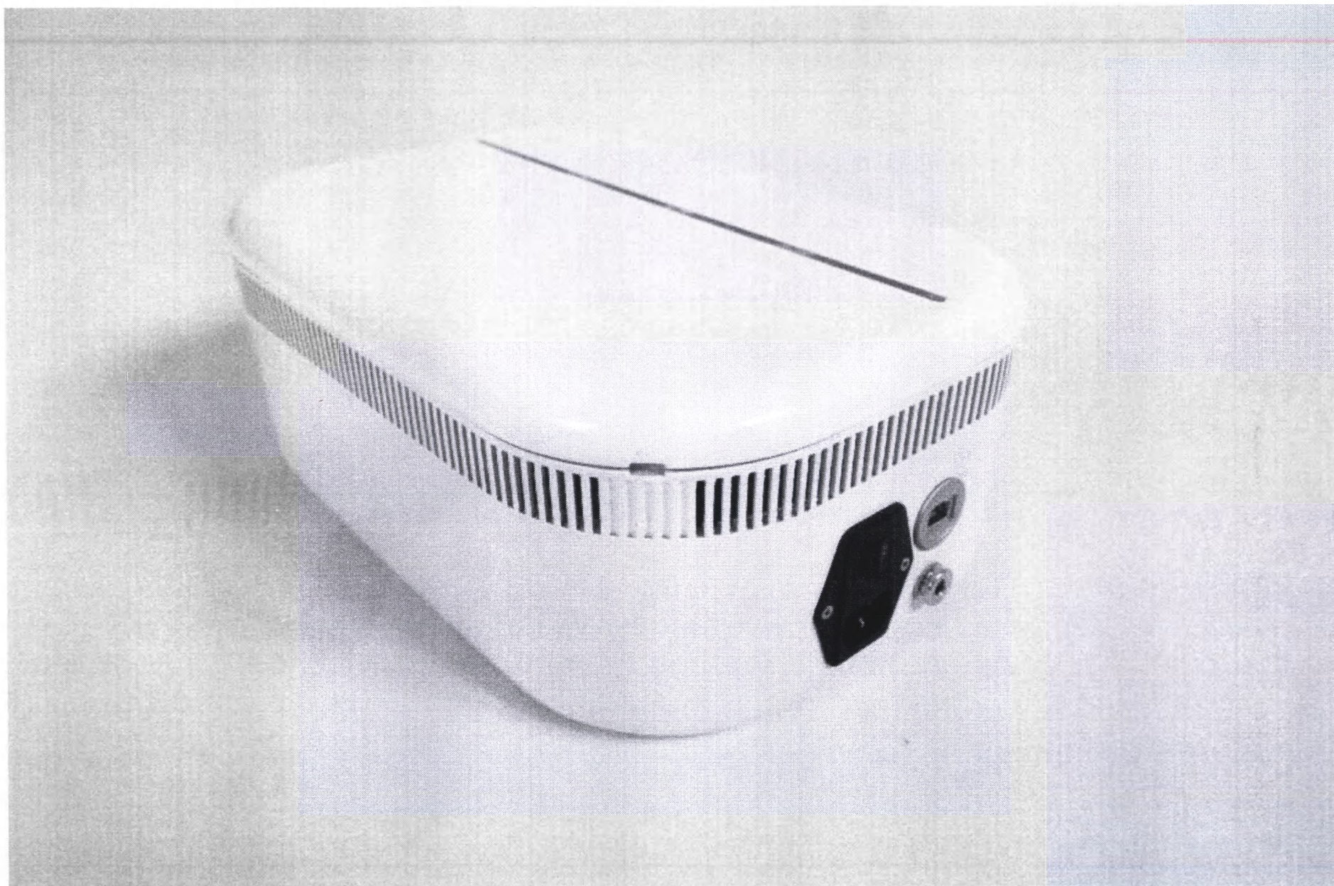
Рис. 9 - Блок управления и электропитания. Вид слева сбоку: разъемы для кабеля питания, кабеля информационного Ethernet, кабеля кнопки аварийного останова
