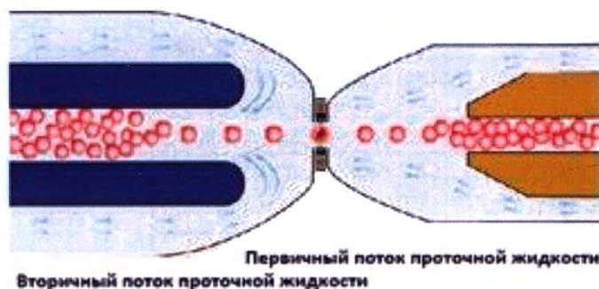
Рисунок 4. Метод импеданса проточной жидкости
